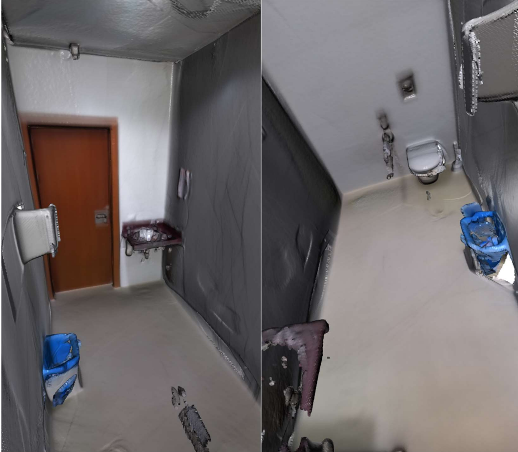
Figura 22: Reconstrucción 3D obtenida (Azure Kinect DK)
