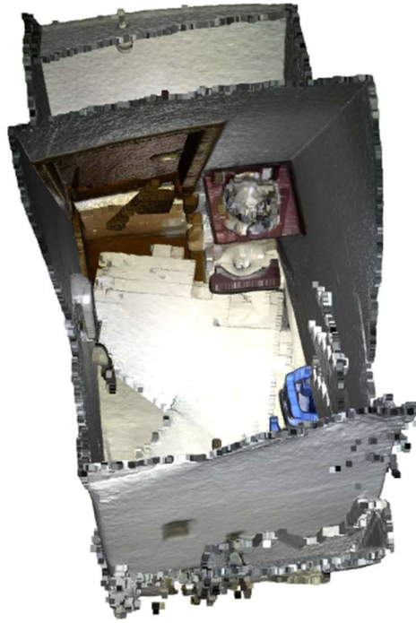
Figura 19: Reconstrucción 3D aumentando la máxima diferencia en profundidad (Intel Realsense D415)
