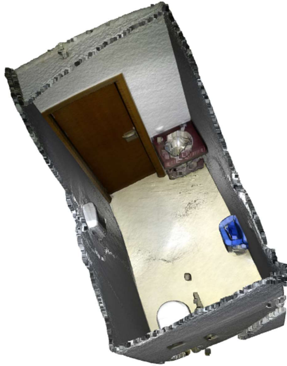
Figura 21: Reconstrucción aplicando un filtro estadístico (Intel Realsense D415)
