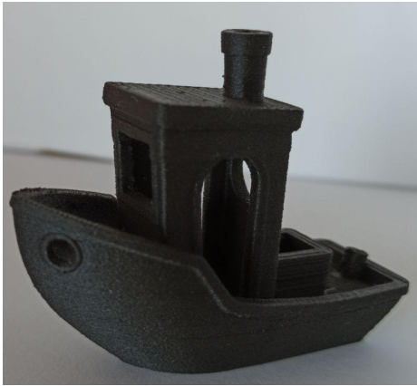
Figura 73: Benchys de calibratge, ABS (Roig), PLA (Blanc) i Nylon fibra de carboni (Negre)
