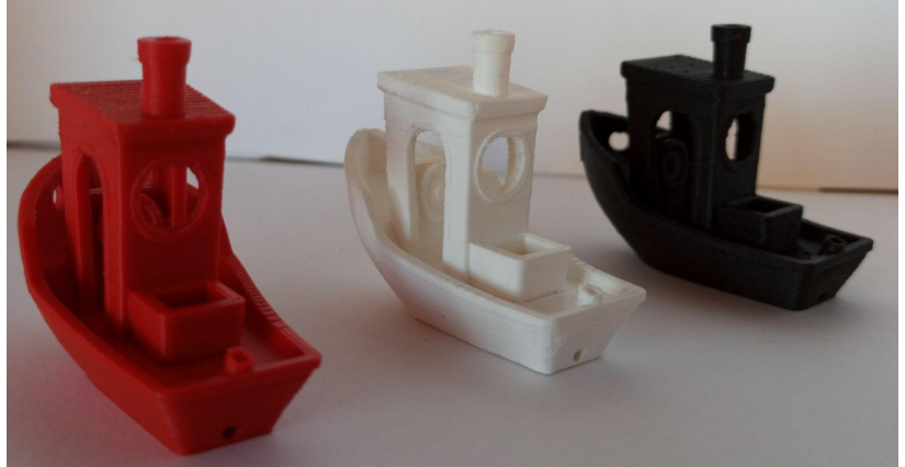
Figura 73: Benchys de calibratge, ABS (Roig), PLA (Blanc) i Nylon fibra de carboni (Negre)
