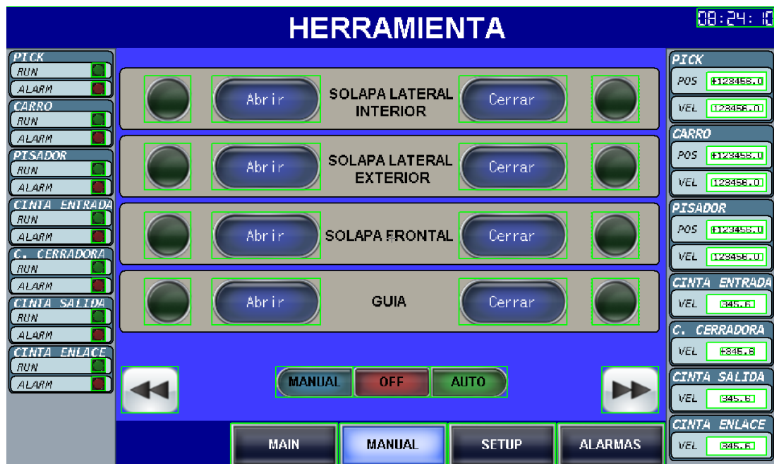
Figura 117: Posicionamiento manual solapas y guía
