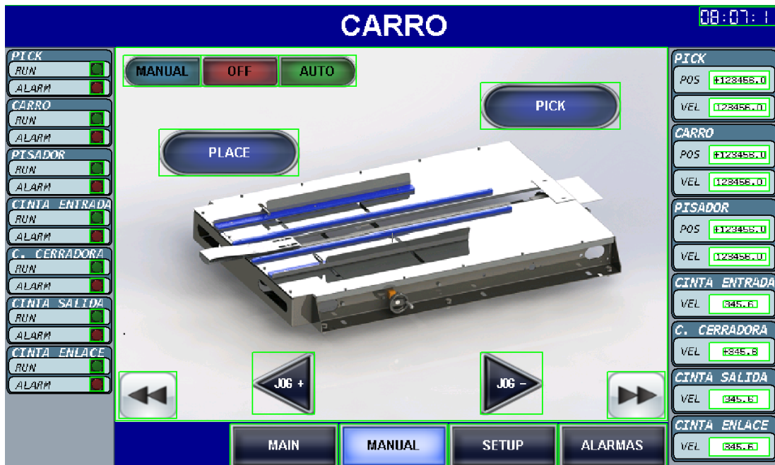
Figura 115: Posicionamiento manual herramienta Carro
