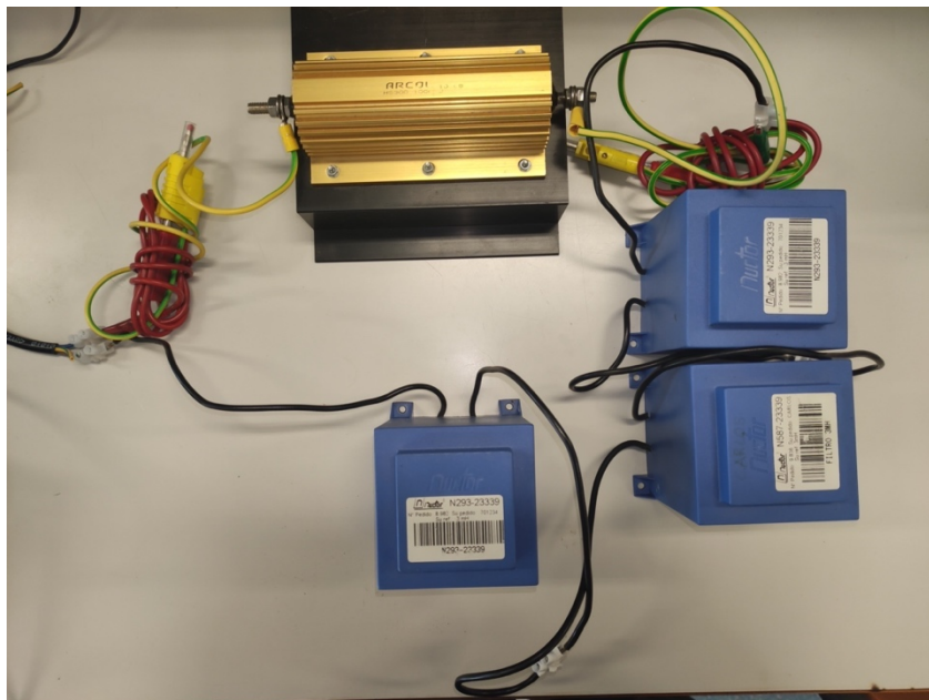
Figura 49: Imagen del circuito experimental montado en el laboratorio.
