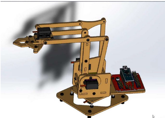
Ilustración 23: Estructura inicial del robot meArm proporcionada en la asignatura de Sistemas Robotizados
