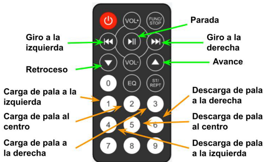
Ilustración 72: Control establecido con mando de IR
