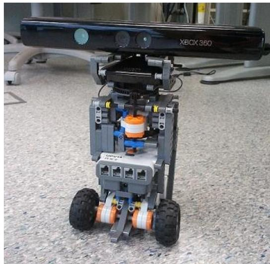
**Figura 90: Aspecto del robot con el sensor Kinect instalado**
