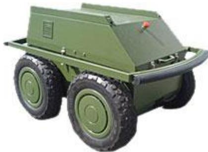
**Figura 15: Robot rodante dotado de 4 ruedas en configuración 2+2**
