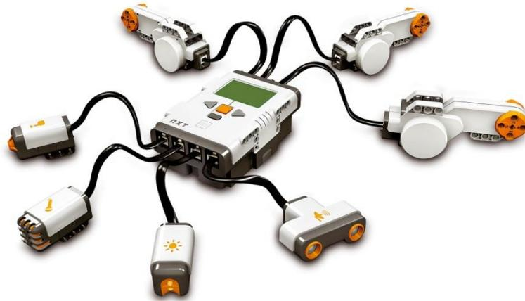
**Figura 51: Ladrillo NXT con todos sus sensores y motores conectados**
