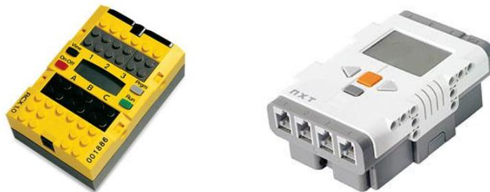
**Figura 49: De izquierda a derecha versiones RCX y NXT del ladrillo de control**
