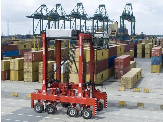
Figura 2. *Straddle carrier* con su configuración característica
