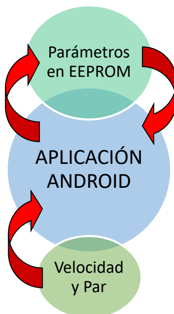
Diagrama 4. Transmisión de información entre aplicación Android e información en ESP32 WROVER - B
