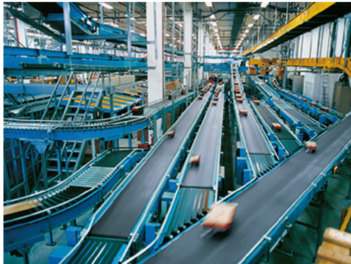
Figura 26. Cinta transportadora en transporte de paquetería. Fuente: Forbo Movement
