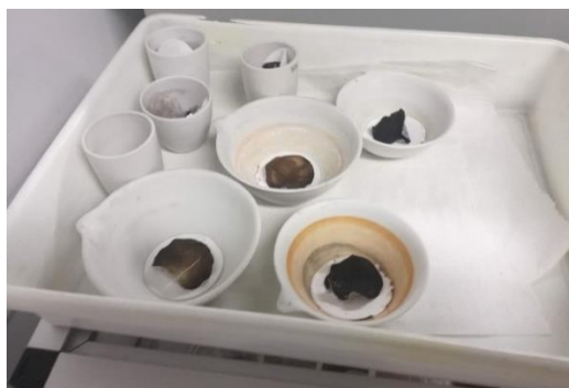
Figura 30. Muestras secas en el crisol antes de pasar por la mufla
