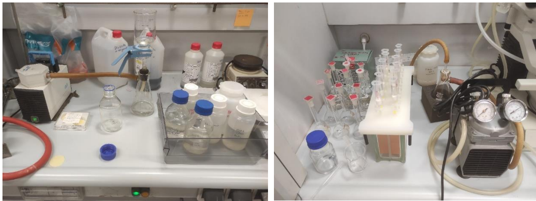
Figura 25. Filtración de muestras a vacío y colocación de cartuchos SPE de forma alterna en equipo de vacío
