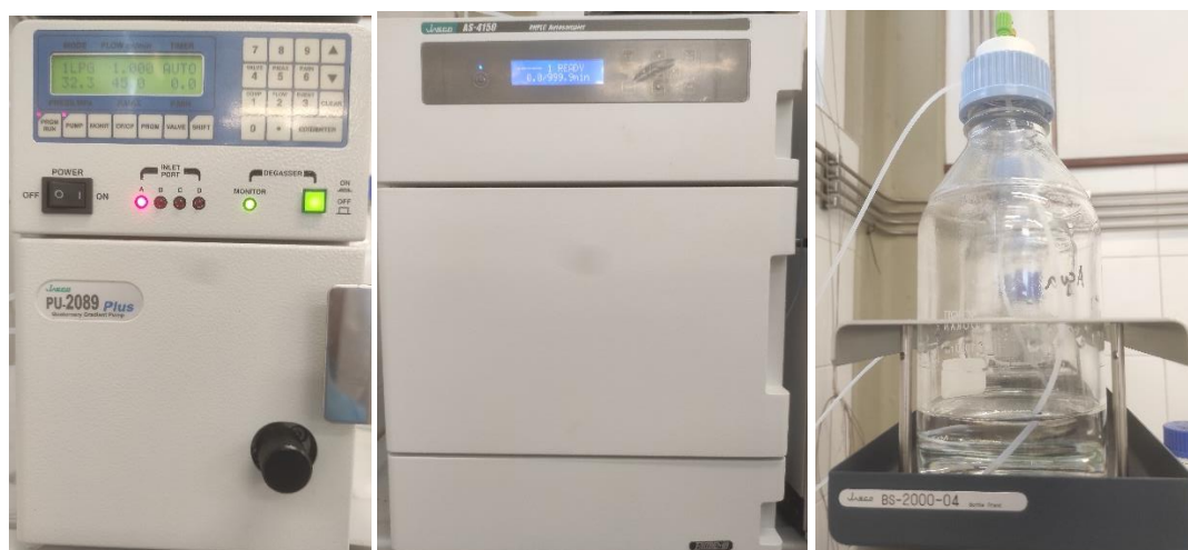
Figura 24. Bomba, cargador de muestras automático y soporte de botellas HPLC
