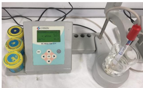
Figura 15. Disposición del conductímetro en el laboratorio para la toma de medidas
