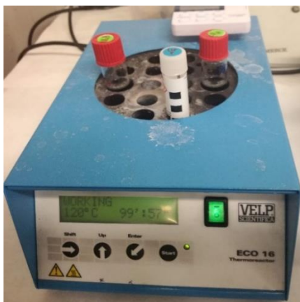
Figura 18. Muestra de nitrógeno total en termorreactor para su disgregación
