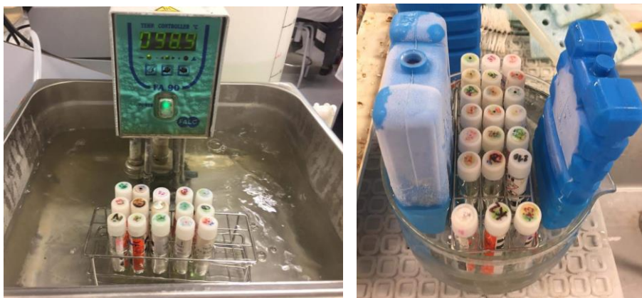
Figura 21. Cubetas de reacción de antrona en baño caliente y en enfriamiento posterior
