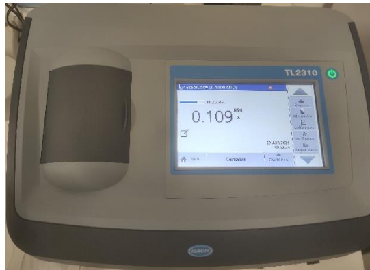
Figura 14. Lectura de turbidez con el turbidímetro
