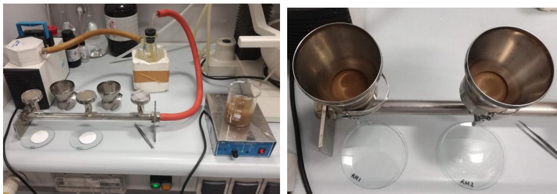
Figura 29. Filtración a vacío de los sólidos del licor de mezcla
