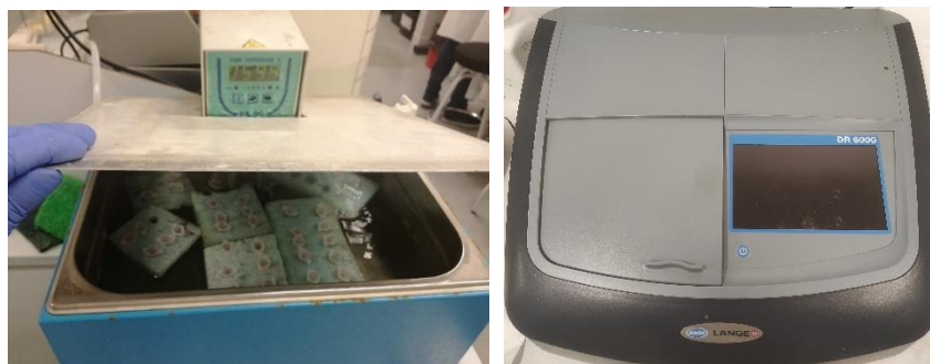
Figura 20. Eppendorfs en el baño caliente para obtener la medida de proteínas y espectrofotómetro empleado
