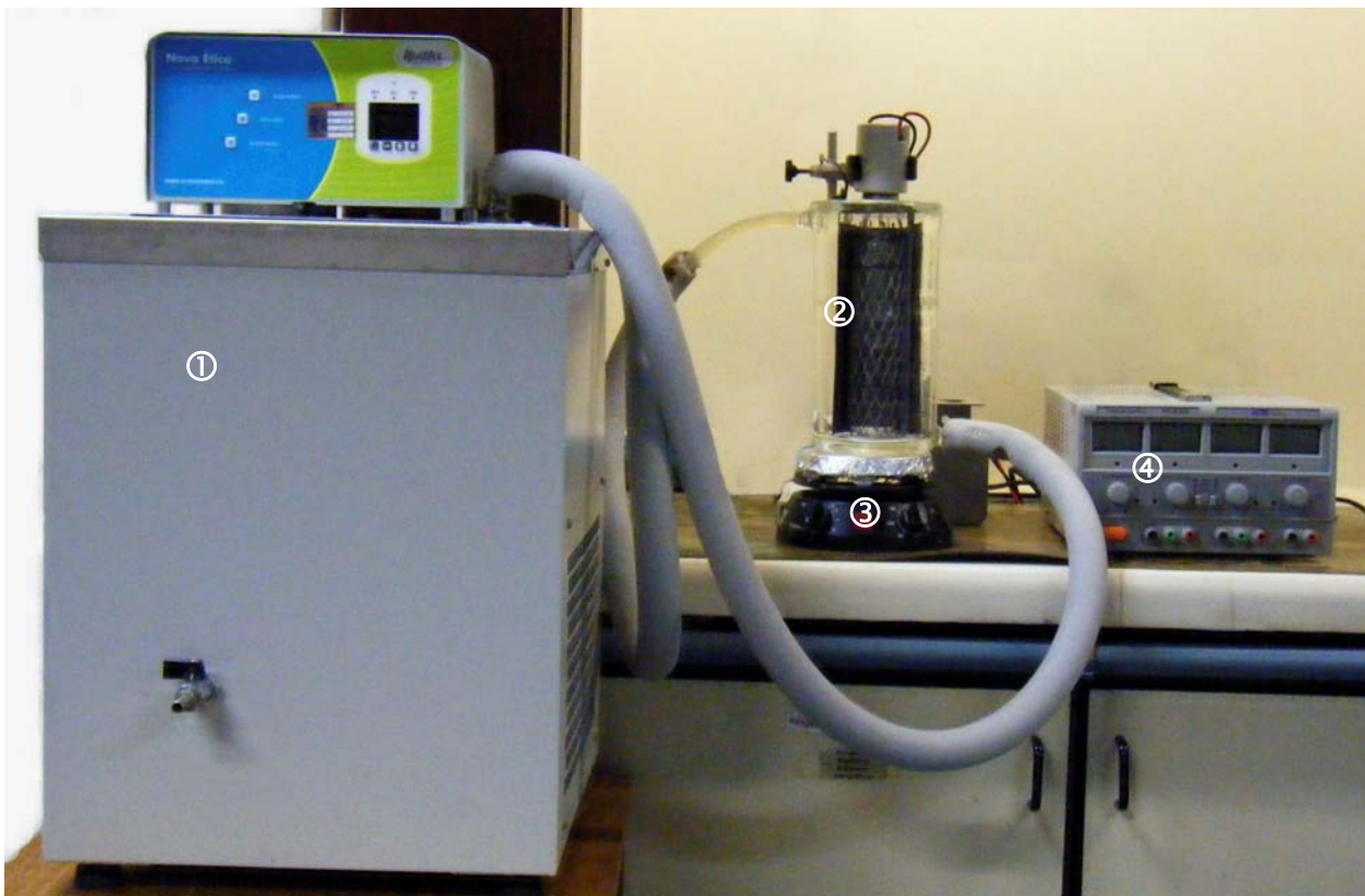
Figura 9: Aparato experimental utilizados nos experimentos de EL e FEO. Sendo: 1) banho ultratermostático, 2) reator de vidro encamisado, 3) agitador magnético e 4) fonte de corrente.
