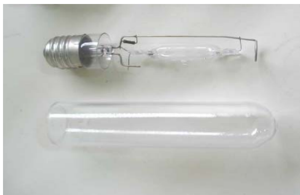
Figura 12: Tubo de quartzo e Lâmpada de vapor de mercúrio, de 250 W de potência.
