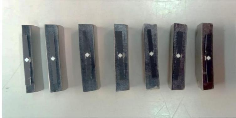
**Figura 12.** Probetas con referencia en forma de diamante blanco listas para el ensayo.
