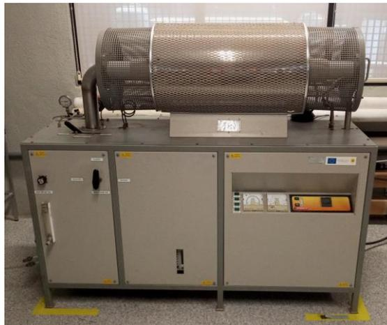
**Figura 9.** Horno tubular de alto vacío Carbolite, modelo HVT 15-75-450.
