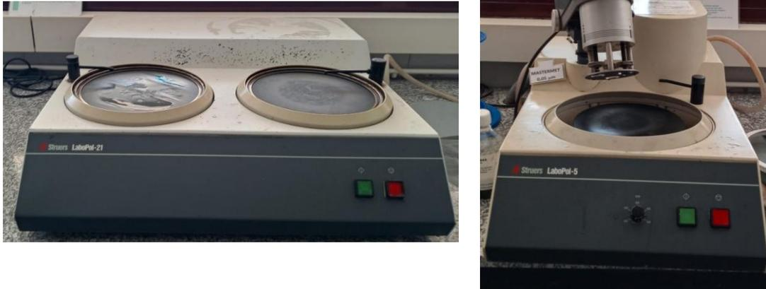
**Figura 15.** Lijadora LaboPol-21 de Struers (izquierda) y pulidora LaboPol-5 de Struers (derecha).
