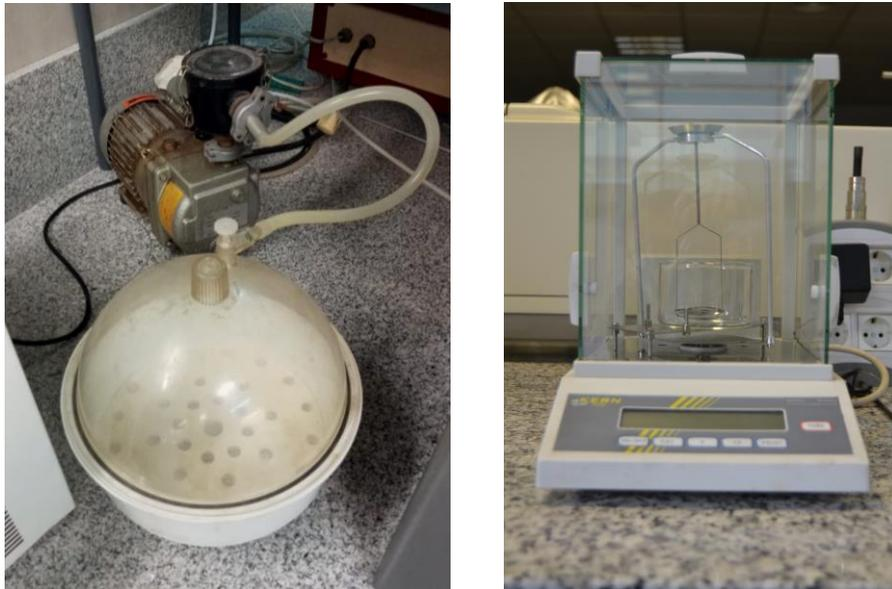
**Figura 10.** Recipiente con bomba de vacío y balanza Kern 770 necesarios para calcular la porosidad mediante el Principio de Arquímedes.
