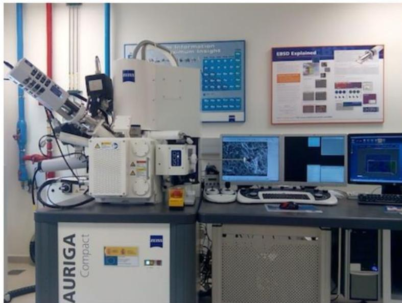
**Figura 16.** Microscopio electrónico de barrido de emisión de campo modelo AURIGA de Zeiss.
