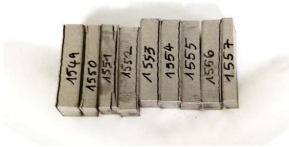
**Figura 8.** Probetas en verde obtenidas.
