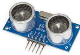
*Figura 5. Sensor de distancia de ultrasonido HC-SR05*
