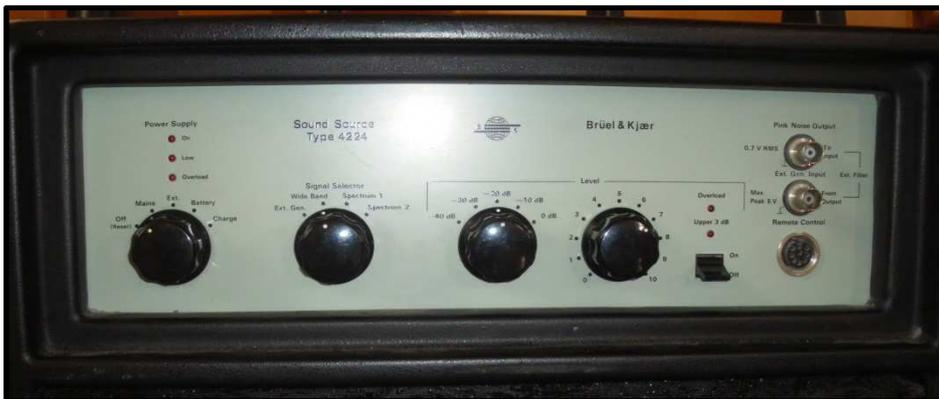
Figura 8. Cuadro de mando de la fuente sonora, con la configuración utilizada.
