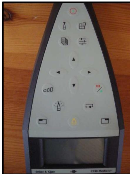
**Figuras 5 y 6.** Sonómetro integrador utilizado en ensayos.
