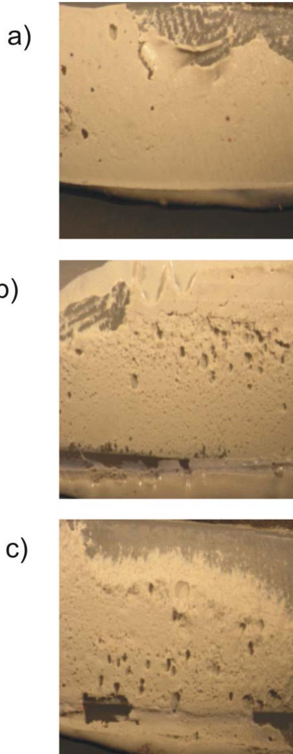
**Figura 112.** Aspecto morfológico del adhesivo de poliuretano tras ensayos de cizalla obtenido mediante lupa estereoscópica (16x) de una muestra sin tratar (a), tratada a velocidades y distancias intermedias (b) y tratada a bajas velocidades y distancias (c).
