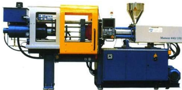
Figura 23. Inyectora utilizada Mateu Sole.
