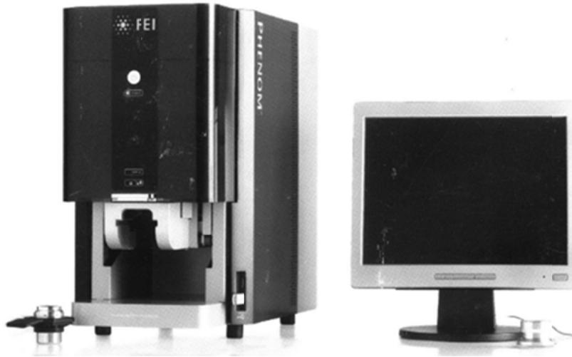
Figura 32. Microscopio electrónico de barrido utilizado.
