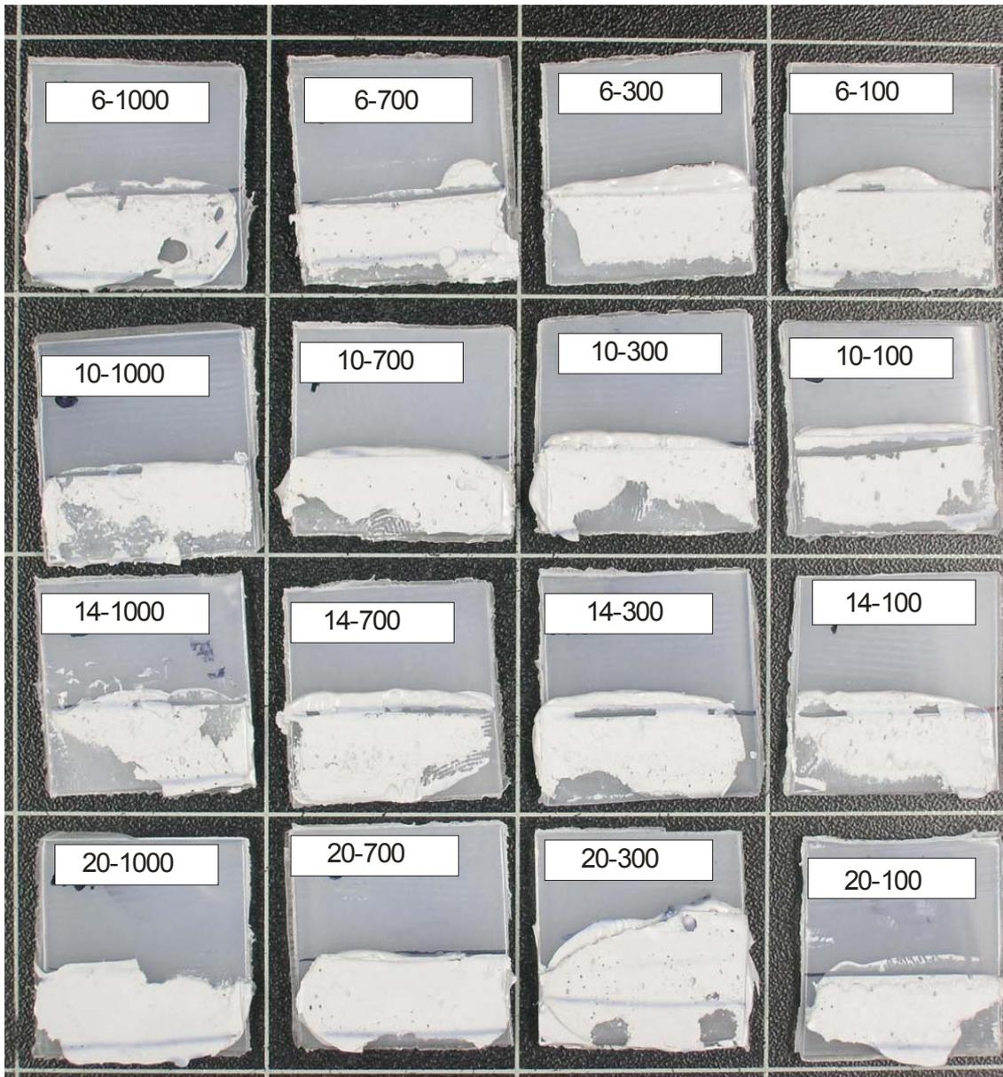
**Figura 111.** Aspecto morfológico de las series analizadas en los ensayos de cizalla.
