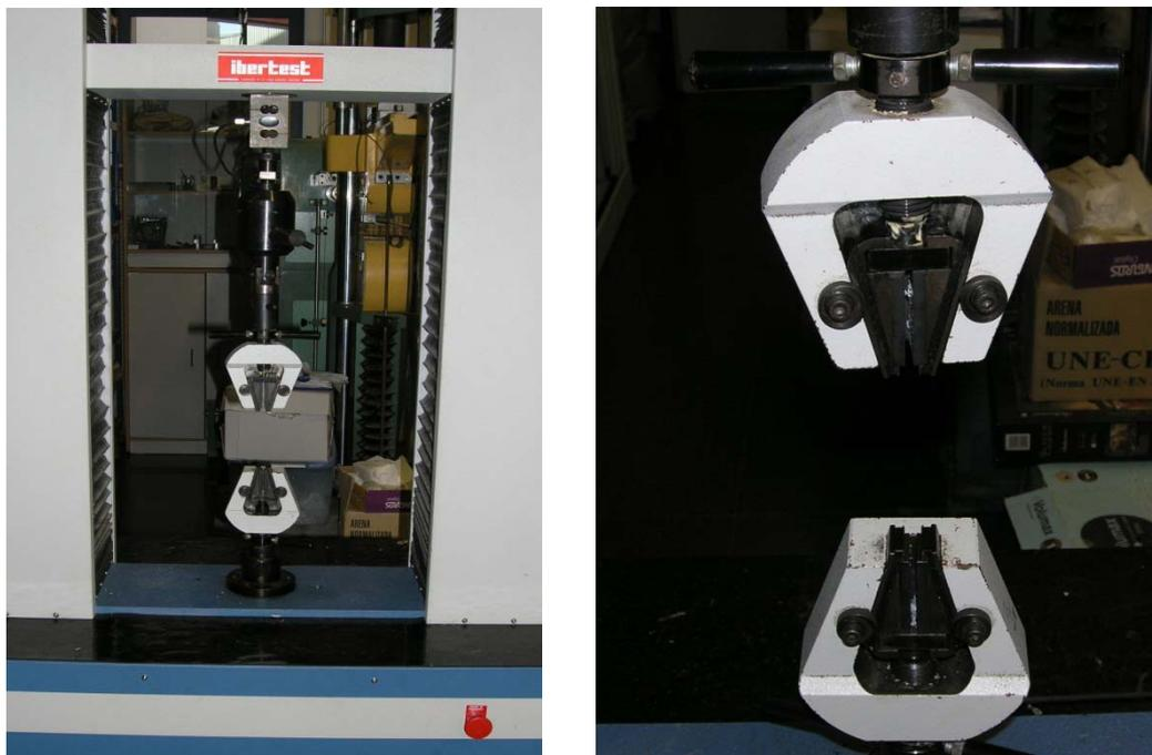
**Figura 31.** Fotografías de la máquina de tracción Elib 50 (Ibertest) y detalle de las mordazas empleadas.
