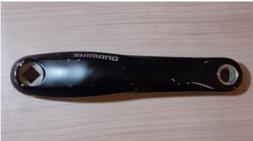
**Figura 19** : Biela de la marca Shimano modelo FC-M442/443.
