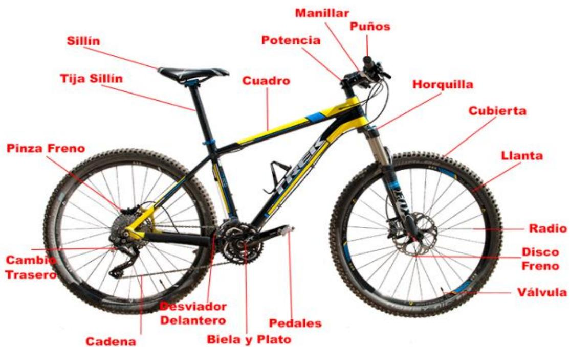
Figura 6: Partes de una bicicleta de montaña.
