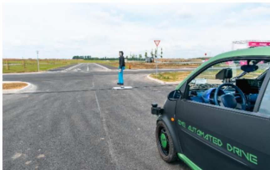
FIGURA 5 - FRENADA AUTOMÁTICA DEL VUT ANTE UN OBSTÁCULO. FUENTE: [26].
