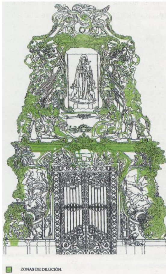
Figura 3.10. Cartografía de patologías. Fuente: El Palacio de Dos Aguas. Claves de su restauración.
