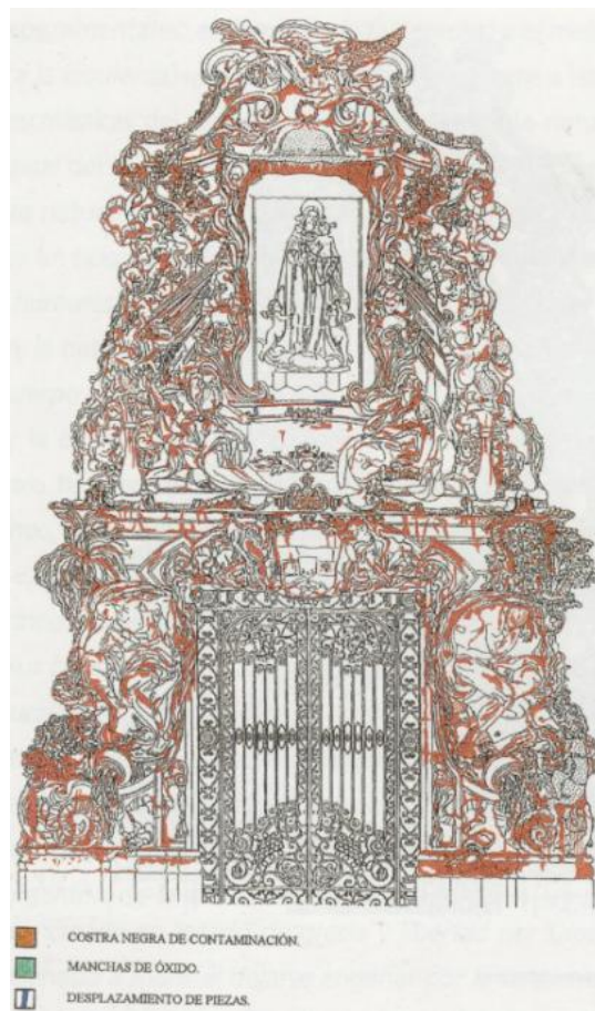
Figura 3.11. Cartografía de patologías. Fuente: El Palacio de Dos Aguas. Claves de su restauración.
