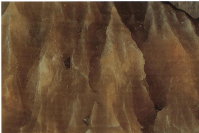
Figura 3.13. Fotografía de las acanaladuras producidas por la dilución del Alabastro.
