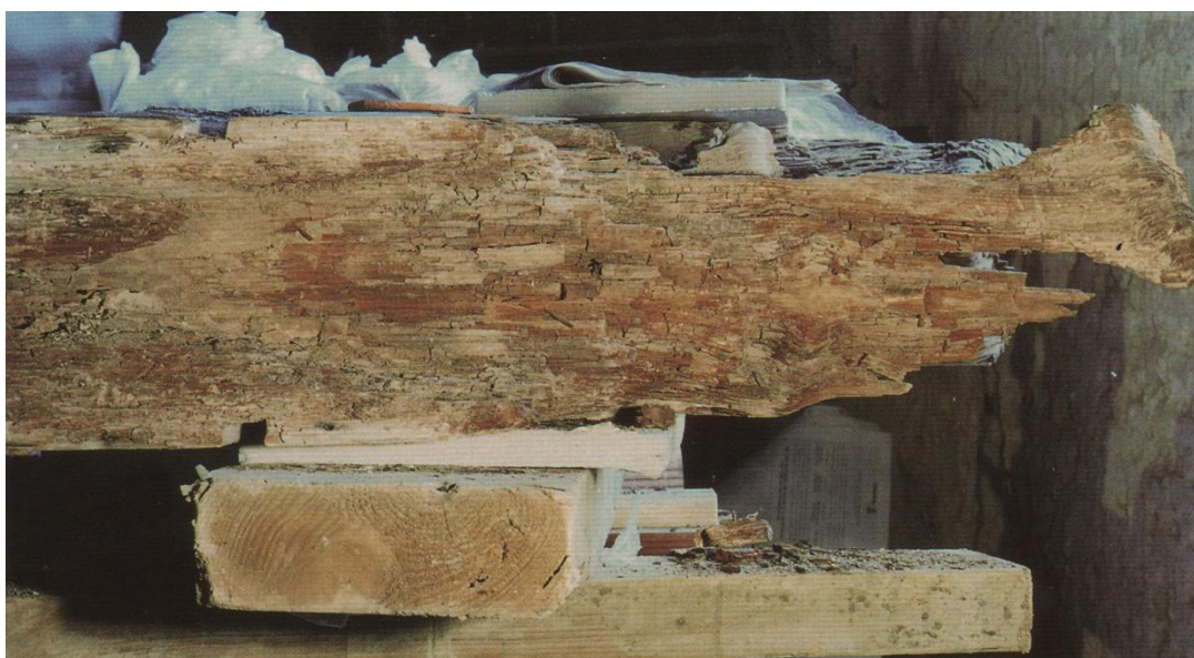
Figura 3.8. Fotografía del detalle del ataque por termitas en una testa y la acción de la pudrición. Fuente: El Palacio de Dos Aguas. Claves de su restauración
