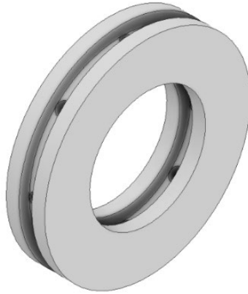
Figura 5.10 - Anillo linterna modelado
