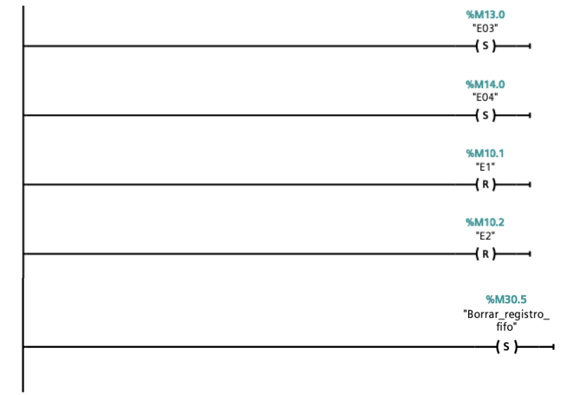
Figura 13. Inicio del proceso en lenguaje LD en TIA PORTAL
