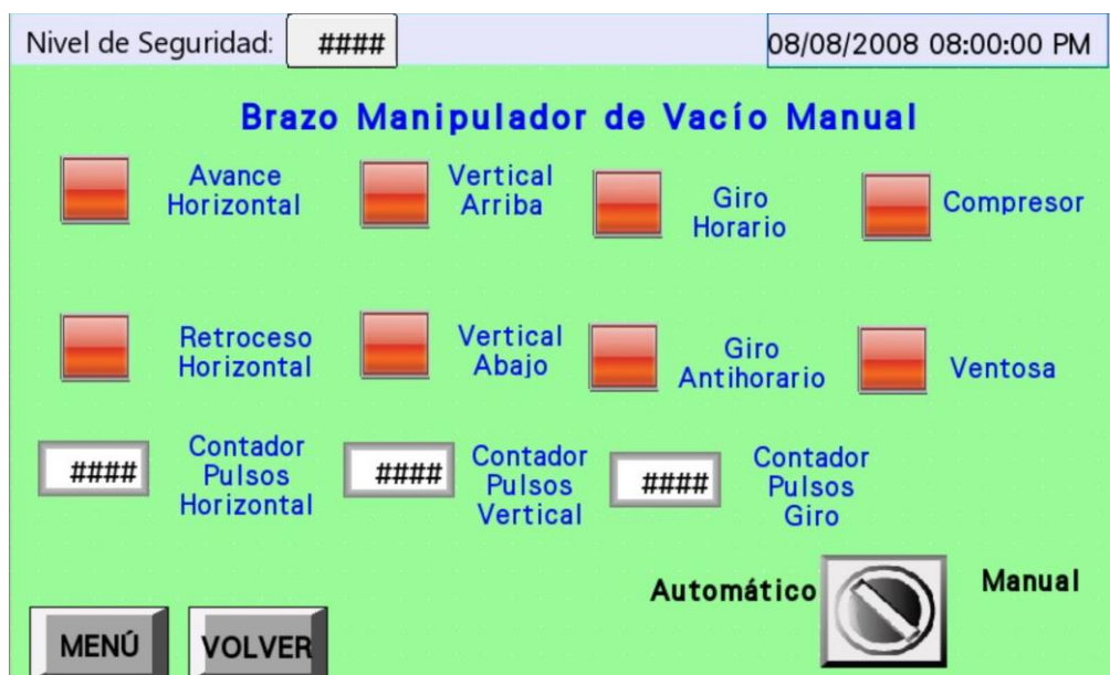
Figura 62. Pantalla de control manual del brazo manipulador a través del HMI
