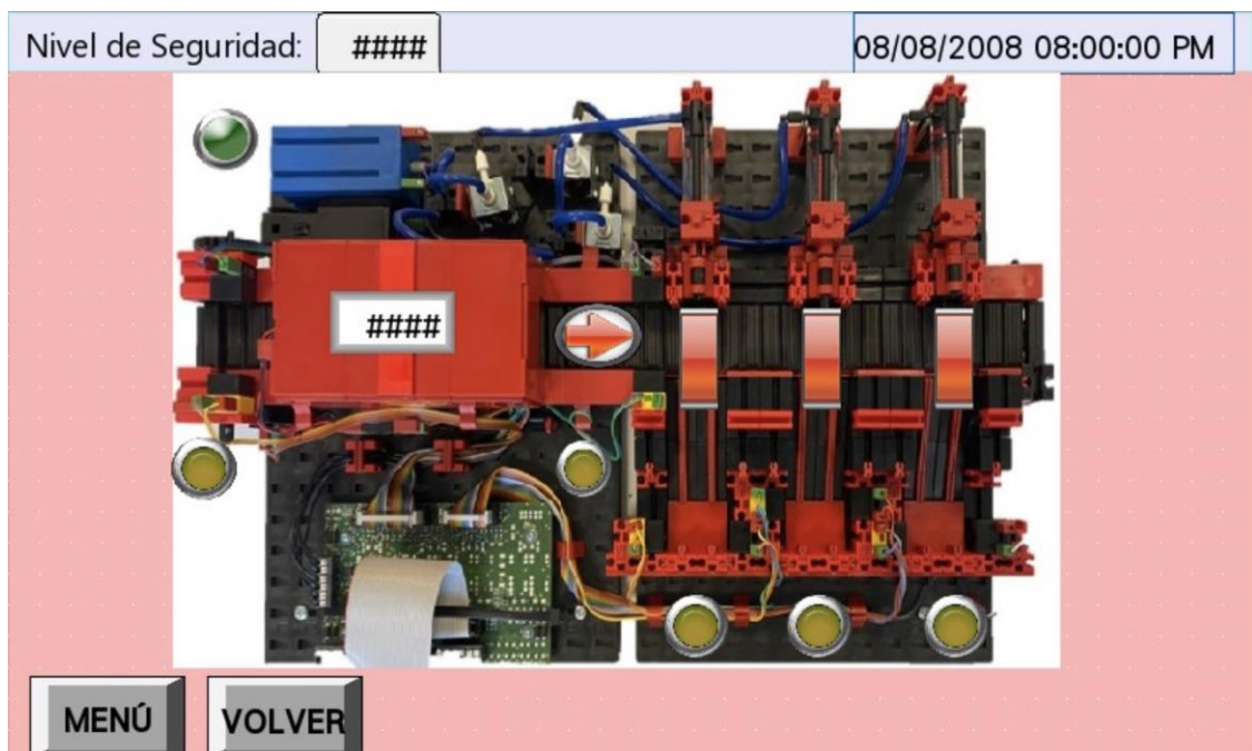
Figura 58. Pantalla de control del clasificador por color del HMI
