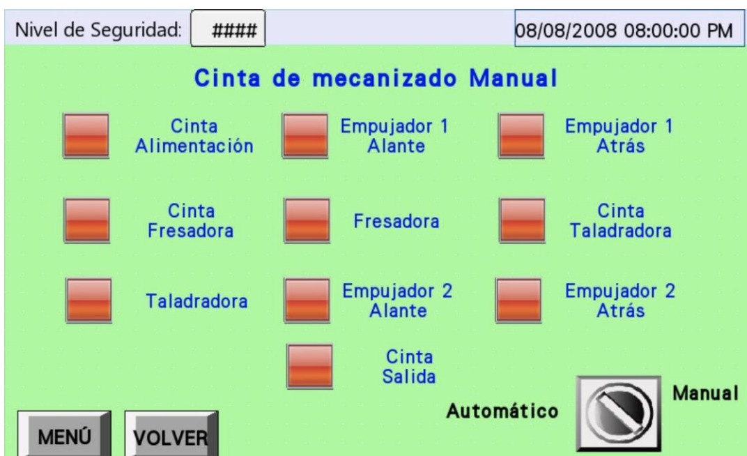
Figura 63. Pantalla de control manual de la cinta de mecanizado a través del HMI
