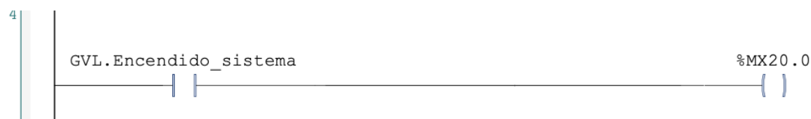
Figura 36. Ejemplo de escritura en el servidor en comunicación entre autómatas Schneider-Schneider
