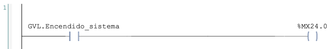
Figura 41. Escritura de una variable del Schneider al Siemens
