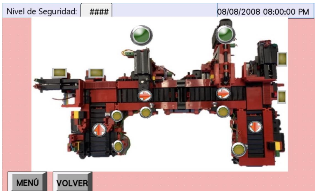
Figura 60. Pantalla de control de la cinta de mecanizado del HMI
