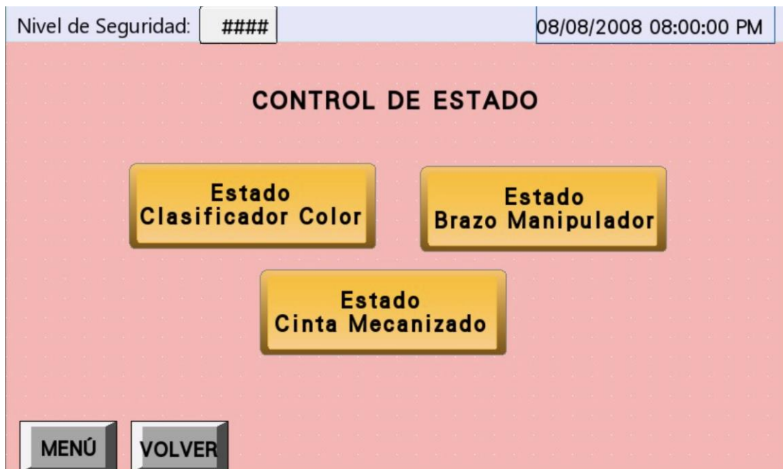
Figura 57. Pantalla de control de estado del HMI
