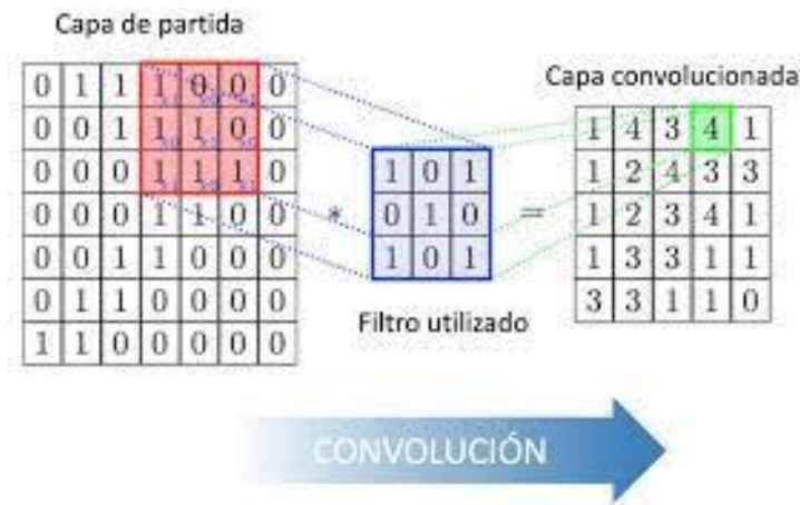
Figura 13. Esquema de una convolución. Fuente: https://www.diegocalvo.es/red-neuronal-convolucional/
