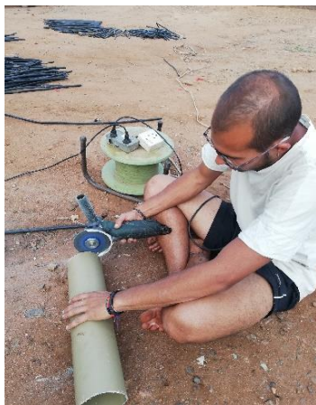
Ilustración 101: Corte de piezas PVC para marimba. Fuente: Propia
