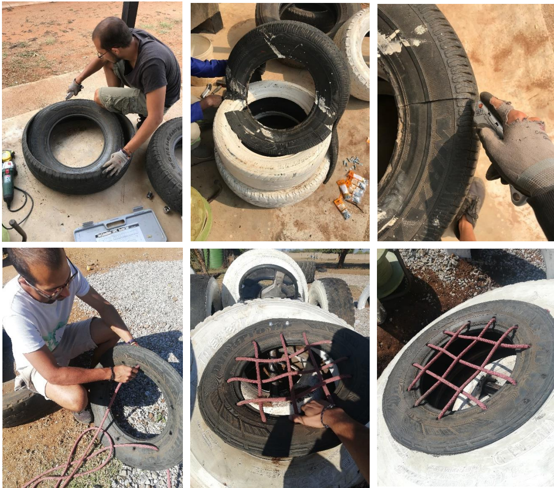
Ilustración 75: Creación del asiento y del capó del coche. Fuente: Propia
