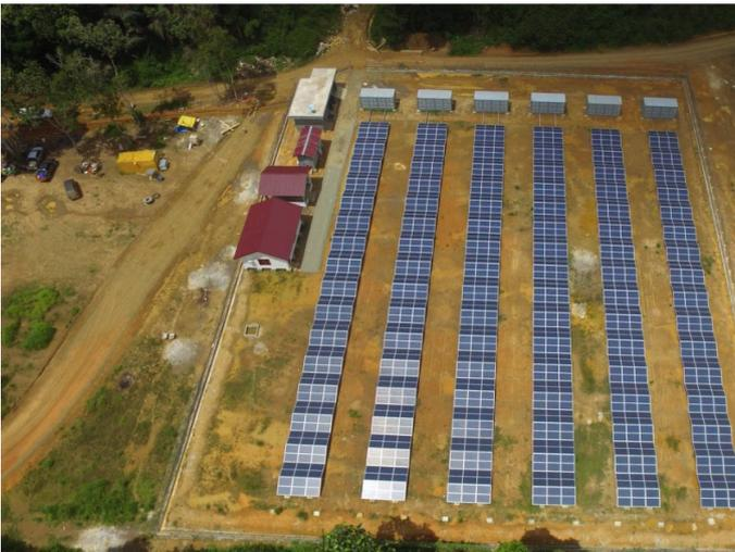
Se puede observar en la imagen la instalación de cinco contenedores de 75 kWp cada uno, lo que supone una instalación total de 450 kWp en menos de 10 horas.
