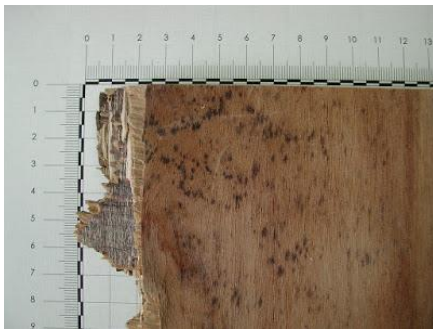
Figura 20. Ataque fúngico sobre tablero de contrachapado.
