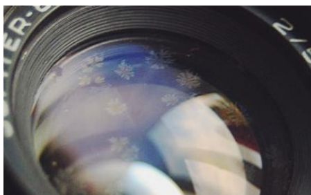
Figura 14. Asentamiento fúngico sobre un objetivo fotográfico de vidrio.
