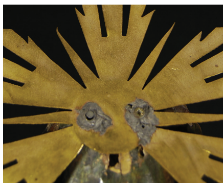
Figura 96. Detalle de la soldadura del clavo y el tornillo sobre la potencia, además de la pérdida de soporte.
