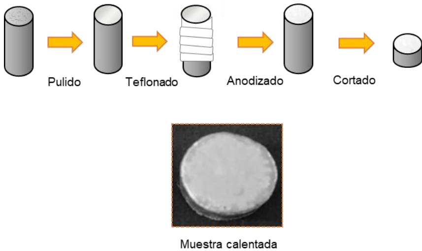
Figura 3.4. Esquema del proceso experimentado por las muestras desde el acondicionamiento hasta la obtención final de la muestra anodizada cortada (arriba). Fotografía de la superficie de la muestra de ZnO tras el calentamiento térmico (abajo).
