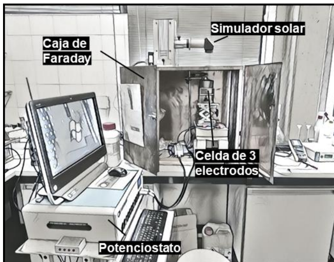
Figura 3.10. Montaje experimental donde se llevó a cabo la caracterización electroquímica y fotoelectroquímica de las muestras de ZnO.
