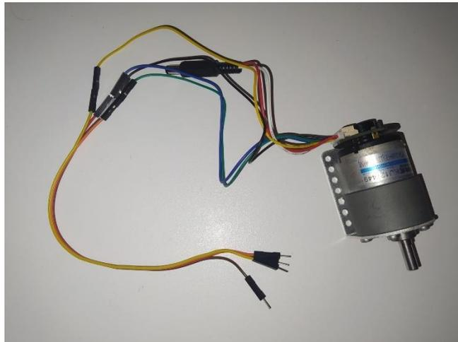
*Ilustración 11 Motor CC + encoder cuadratura*
