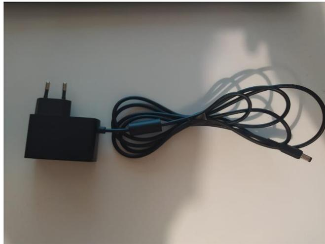
*Ilustración 24. Adaptador de corriente*
