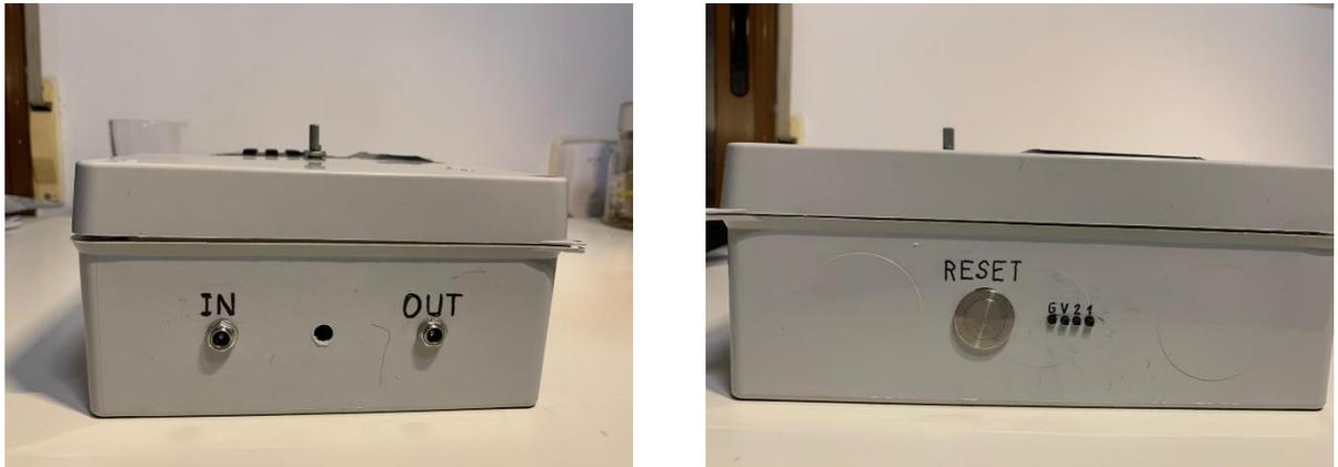
*Ilustración 29. Vista conexiones de alimentación del controlador y del motor (izq) y vista conexiones del encoder del motor (der)*
