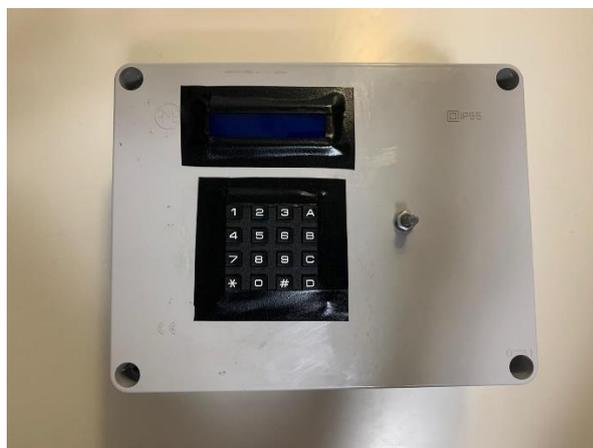
*Ilustración 30. Vista de la tapa de la caja con el teclado, encoder y pantalla*
