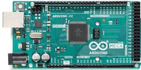
*Ilustración 10. Arduino MEGA 2560. Fuente: Arduino.cc (2021)*
