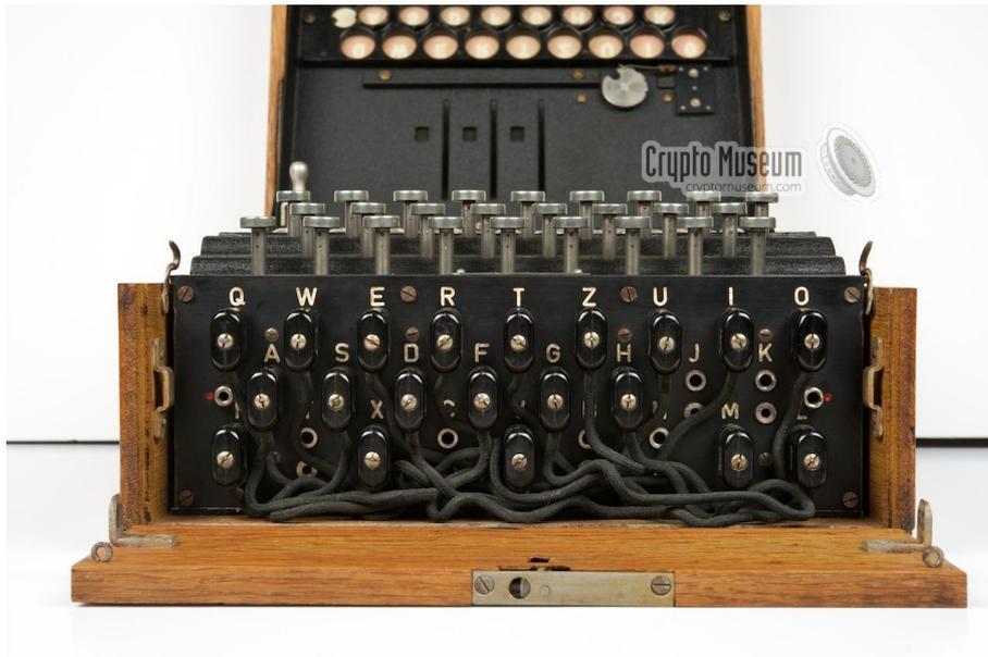
Figura 3.3: Fotografía del panel de cables de un modelo militar I. Cortesía del Crypto Museum.
