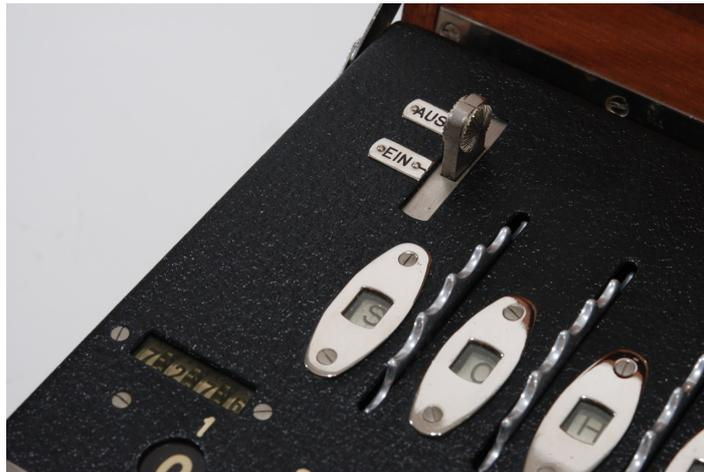
**Figura 4.11:** Fotografía de la parte superior izquierda de una Enigma G, donde se puede ver el contador de longitud y la palanca para bloquear los engranajes de giro. Cortesía del Crypto Museum.
