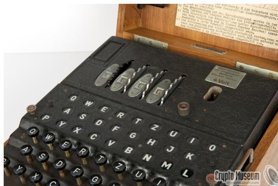
**Figura 4.10:** Fotografía de la parte superior de una Enigma M4. Nótese la rueda negra, que es la del rotor extra. Cortesía del Crypto Museum.
