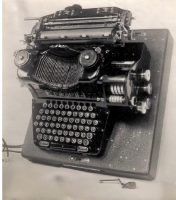
**Figura 4.2:** Una máquina Enigma de escribir, cuya base forma parte de la máquina.
