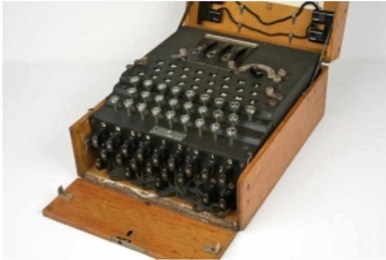
**Figura 4.8:** Fotografía de una Enigma I. Nótese el panel de cables.
