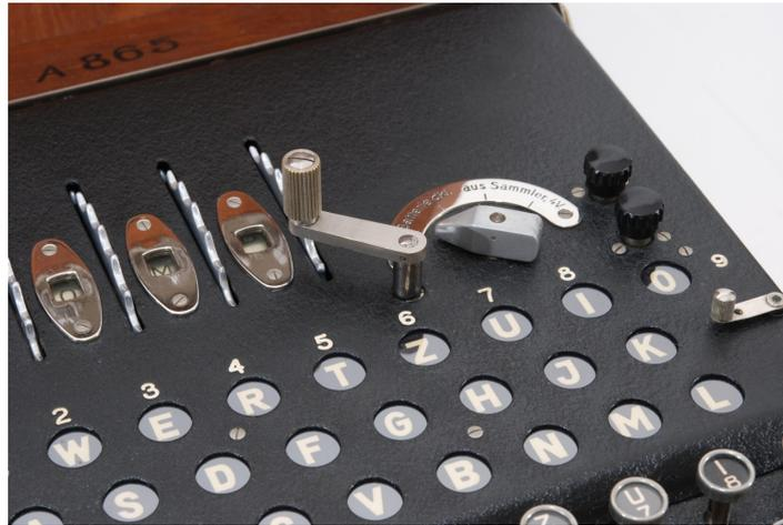
**Figura 4.12:** Fotografía de la parte superior derecha de una Enigma G. Nótese la manivela para avanzar y retroceder el mecanismo de giro. Cortesía del Crypto Museum.
