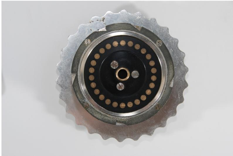
**Figura 4.14:** Fotografía del reverso de un rotor de la Enigma T, donde se pueden ver a la perfección las cinco muescas.
