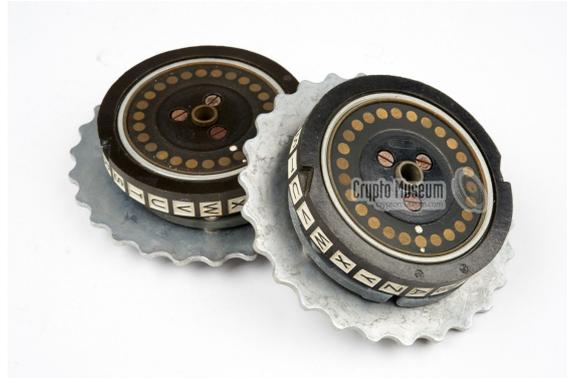
**Figura 3.2:** Fotografía de los rotores IV y VII de los modelos M. Se pueden apreciar las dos muescas en el rotor VII. Cortesía del Crypto Museum.
