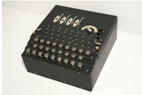
**Figura 4.6:** Fotografía de una Enigma K sin su caja de transporte. Es prácticamente indistinguible del modelo D. Este modelo concreto fue usado por oficiales ferroviarios. Cortesía del Crypto Museum.
