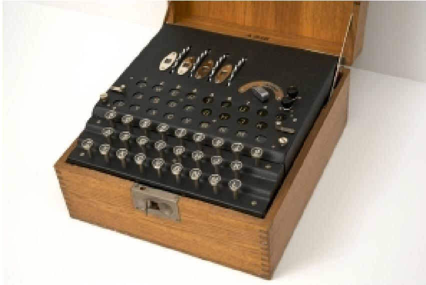
**Figura 4.5:** Fotografía de una Enigma D dentro de su caja. Nótese la nueva distribución del teclado y lamparas. Cortesía del Crypto Museum.
