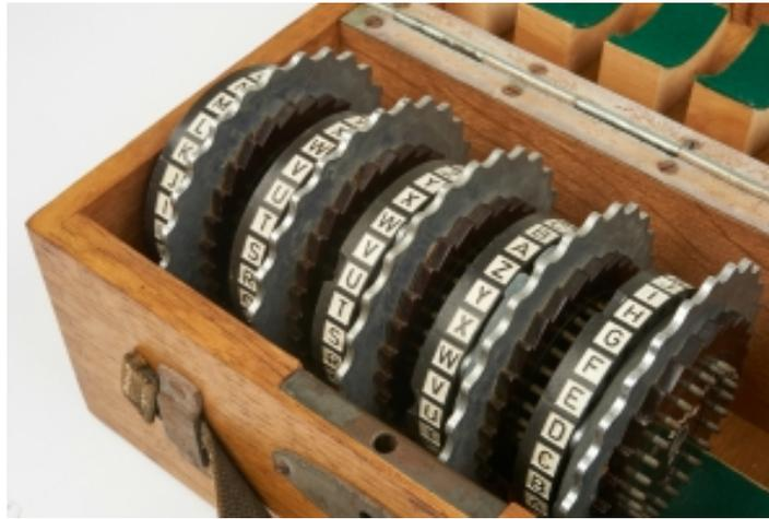
**Figura 4.9:** Fotografía de una caja donde se almacenan los rotadores de las Enigma M que no estaban en uso. Aquí se ven cinco, más los tres que habría en la máquina, suman ocho.
