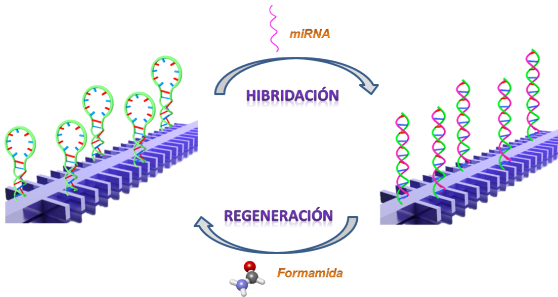
Figura 5.16. Representación esquemática de sendos eventos: bioreconocimiento de miRNAs y regeneración química del sensor, siendo éste una estructura de band gap fotónico biofuncionalizada con sondas MB.
