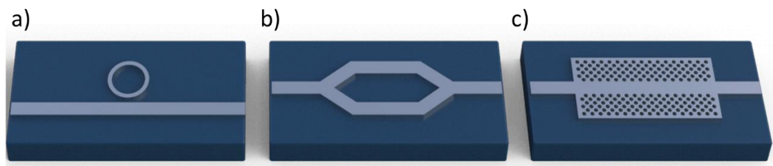
Figura 1.5. Representación de las configuraciones típicas de estructuras fotónicas integradas: a) anillo resonante; b) interferómetro Mach-Zehnder; c) cristal fotónico.
