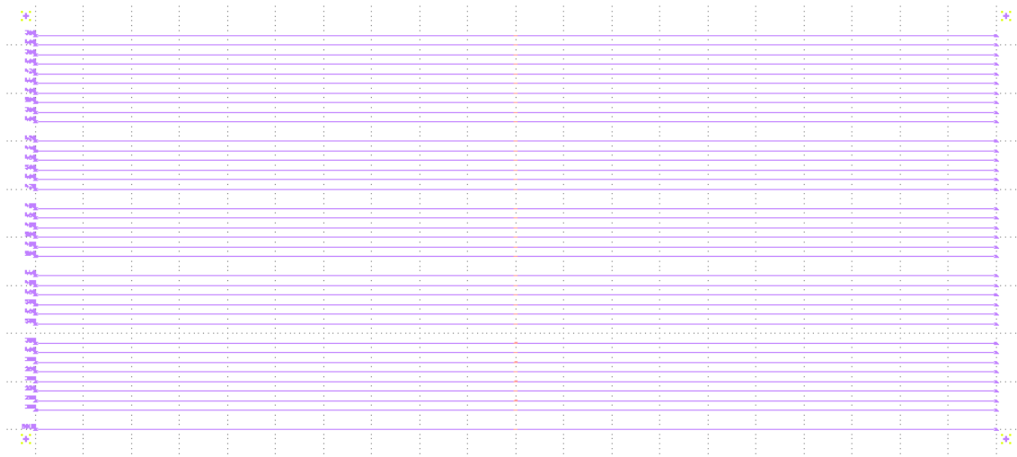
Figura 2.15. Ejemplo de un diseño de un chip fotónico cuya distancia entre sus accesos de entrada y de salida es 10 mm.
