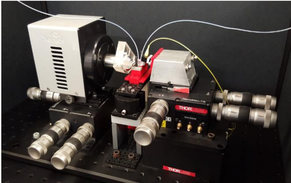
Figura 3.17. Imagen de la plataforma de interrogación óptica basada en la continua adquisición de la respuesta espectral de estructuras nanofotónicas mediante una cámara IR.
