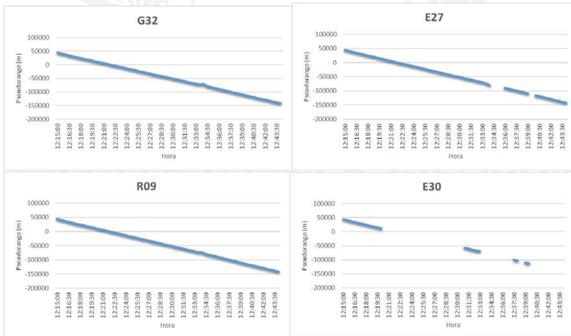
Ilustración 9. (SPP) Discrepancia de pseudorangos en función del tiempo
