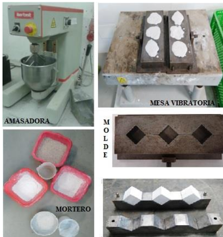
Figura 37 Equipo y materiales usados en la preparación de morteros
