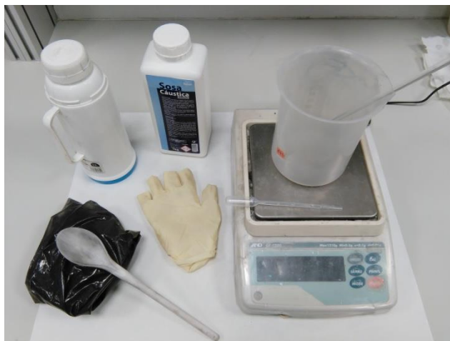
Figura 35 Equipo y materiales usados para la preparación de las disoluciones alcalinas con fuente de sílice alternativa
