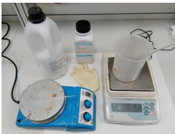
Figura 34 Equipo y materiales usados para la preparación de la disolución activadoras con reactivos comerciales
