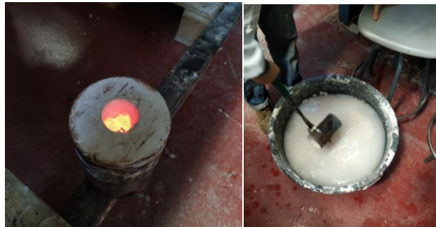
Fig. 40. Lucía Gómez Gallego. Molde refractario con el metal aún candente en su interior. Posteriormente se sumerge para que el cambio de temperatura lo diluya y aparezca la pieza de metal.
