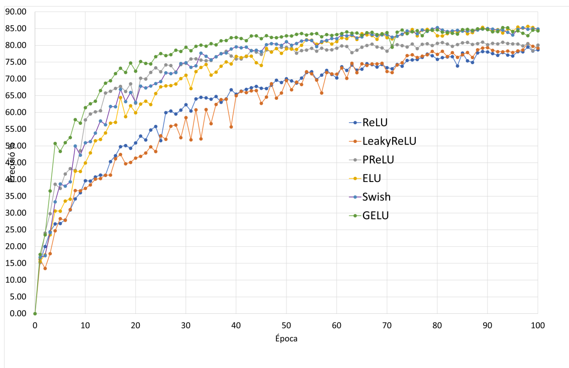
Figura 6.8: Evolució de la precisió en l'entrenament del model VGG16 amb el dataset CIFAR 10 en les 6 funcions d'activació estudiades.
