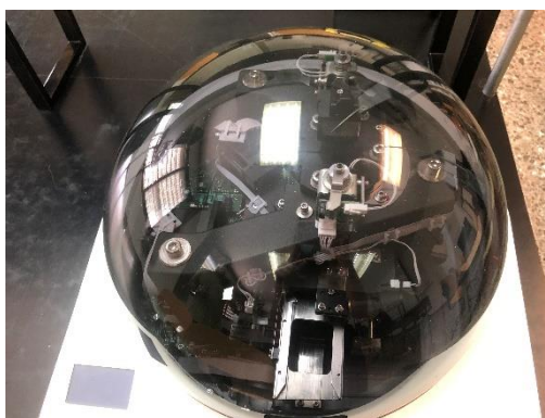
Figura 26. Microscopio para la lectura del slide una vez revelado.
