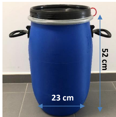
Figura 9. Bidón impermeable al radón utilizado como equipo experimental.
