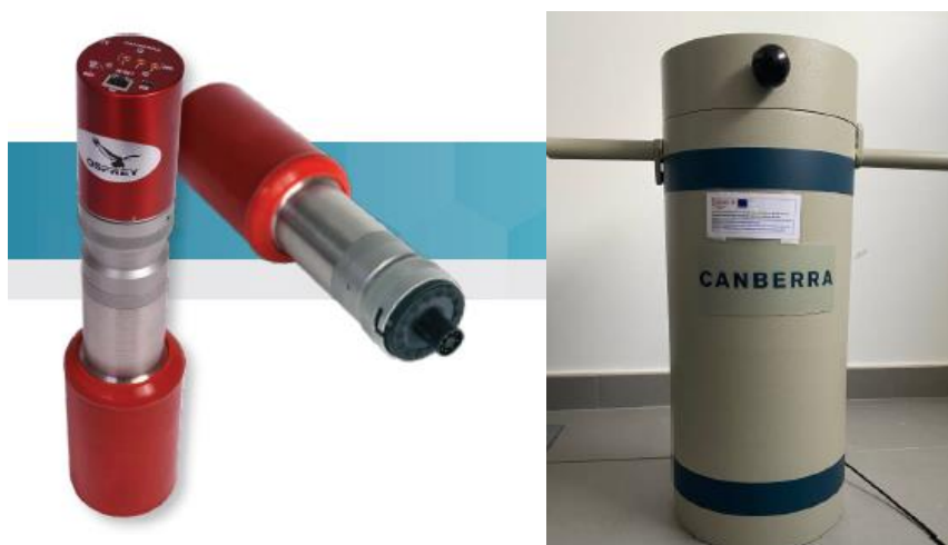
Figura 13. Detector de yoduro con analizador multicanal y blindaje ( NAIS-3x3™ NaI LED Temperature-Stabilized* Scintillation Detector , n.d.).
