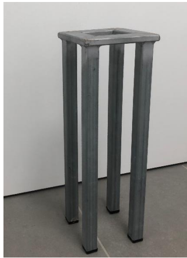
Figura 29. Soporte metálico utilizado en los ensayos de medición de radón en el aire.
