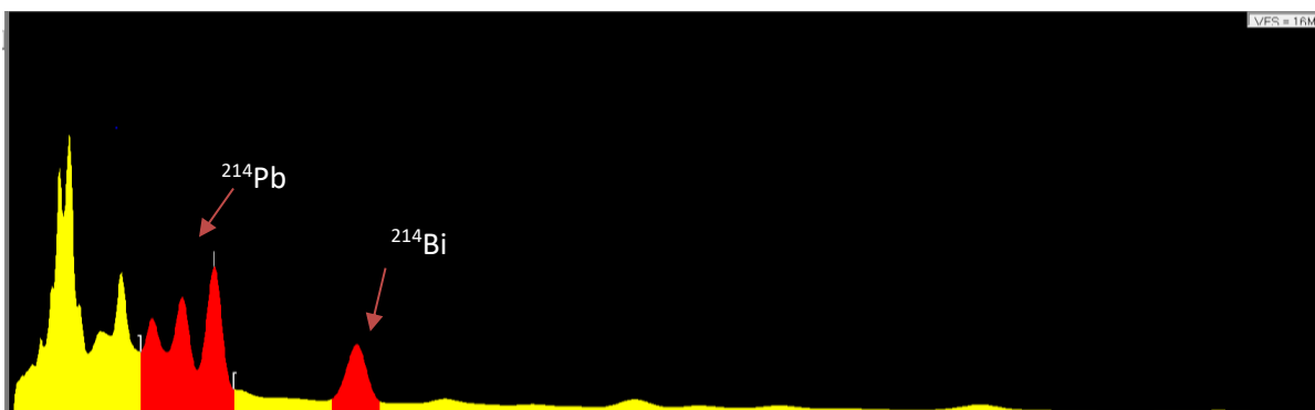
Figura 38. Espectro de la fuente natural de ^{238}\text{U} utilizada en los ensayos de medición de radón en aire.
