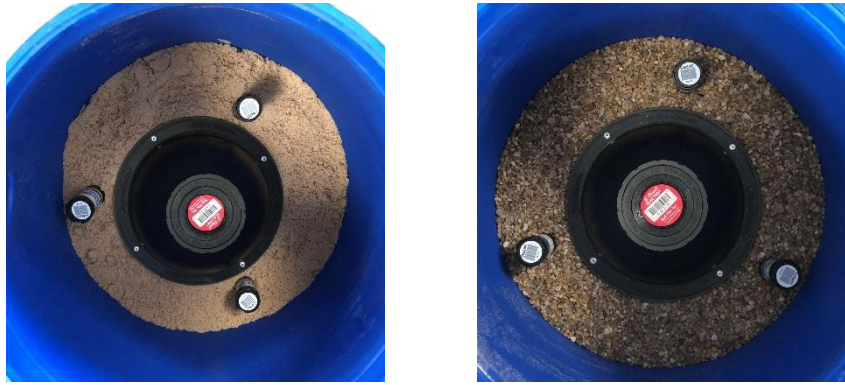
Figura 37. Montaje experimental de los ensayos de radón exhalado para cada tipo de arena.
