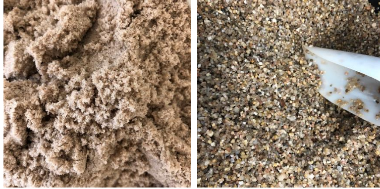
Figura 49. Arenas en el estado inicial en el estudio de la influencia de la humedad.
