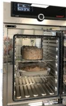
Figura 33. Estufa con arena para el secado de esta.
