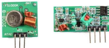
*Figura 10: Módulos de transmisión inalámbrica por RF de 433MHz, emisor (derecha) y receptor (izquierda).
