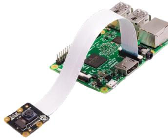
*Figura 5: Raspberry Pi 2B con la cámara PiNoIR conectada. Fuente: página web de la fundación Raspberry Pi.*
