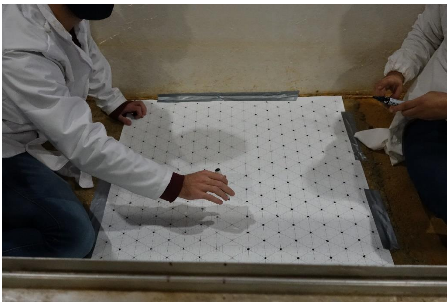
Figura 3.13. Proceso constructivo: malla de colocación. Fuente: LPC-UPV.
