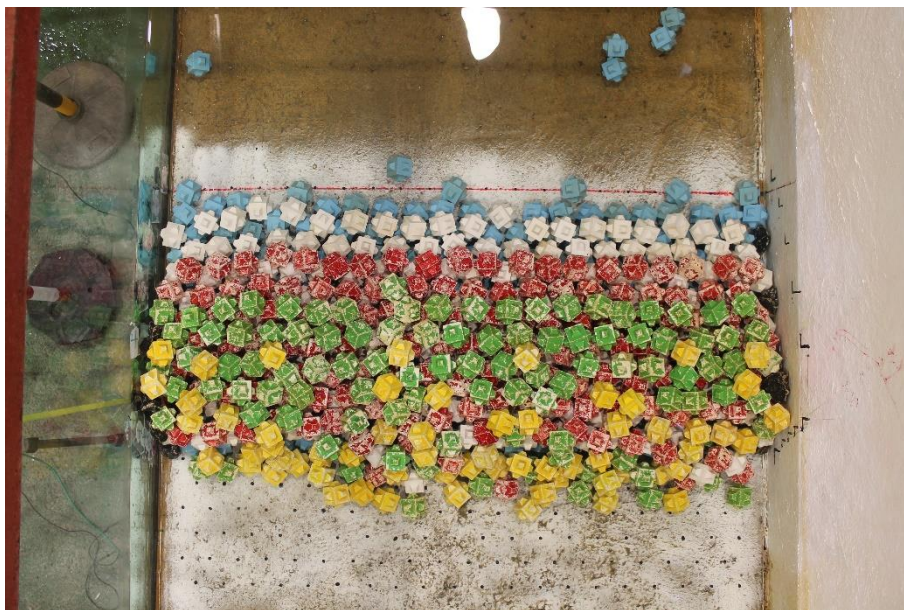
Figura 3.23. Inicio de Destrucción. Fuente: LPC-UPV.
