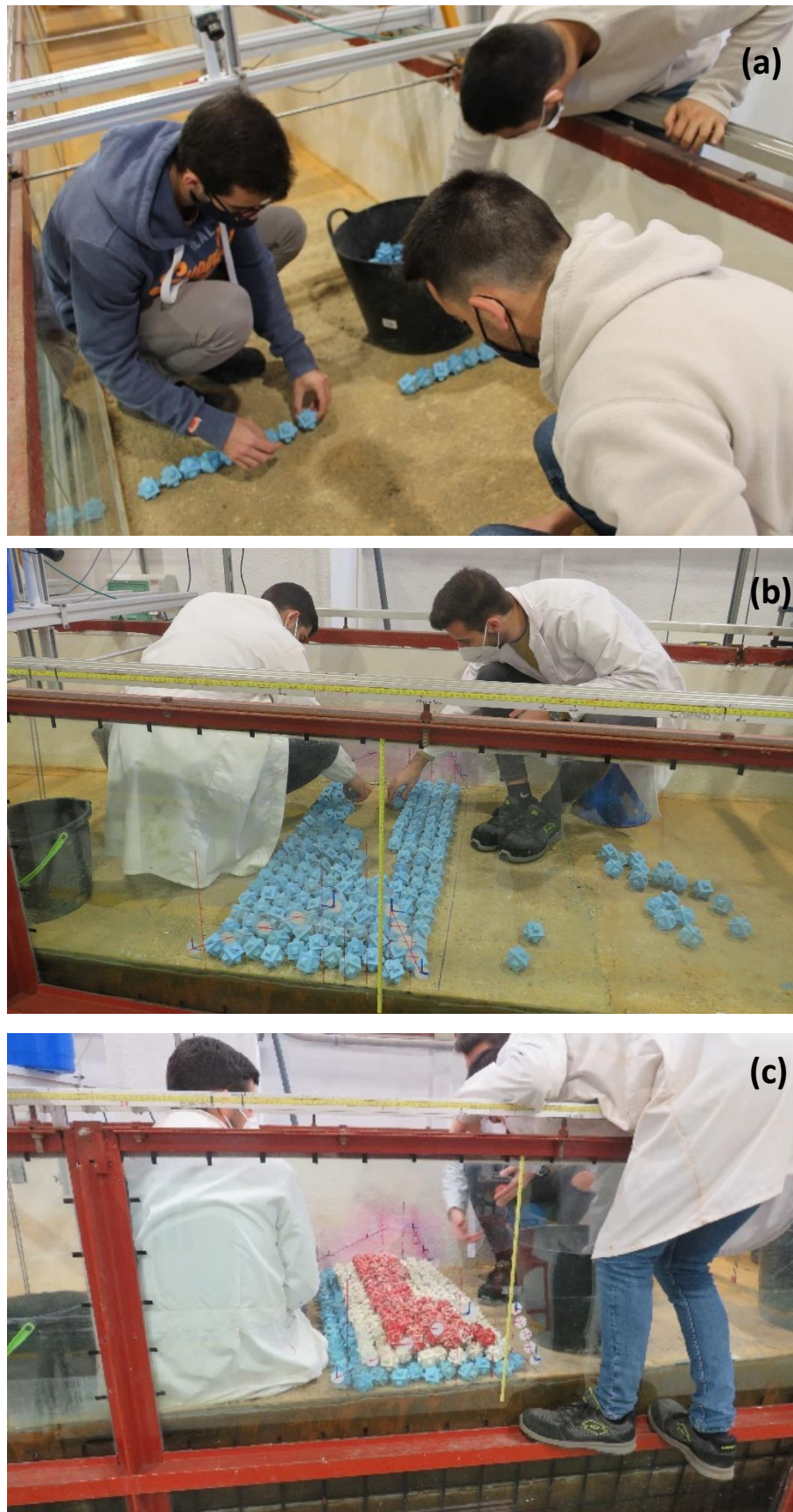
Figura 3.14. Proceso constructivo: (a,b) Construcción de la 1ª capa (c) Construcción de la 3ª capa. Fuente: Elaboración propia.
