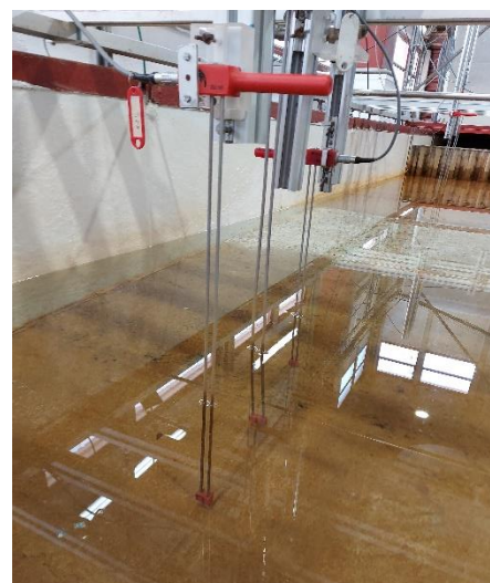
Figura 3.6. Sensores de nivel en la zona de generación (izquierda) y frente al modelo (derecha). Fuente: Elaboración propia.
