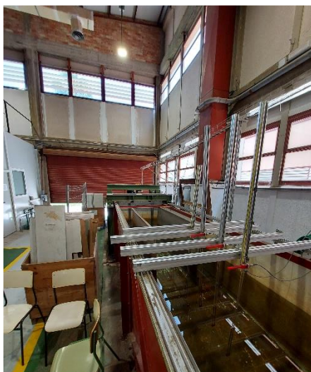
Figura 3.6. Sensores de nivel en la zona de generación (izquierda) y frente al modelo (derecha). Fuente: Elaboración propia.
