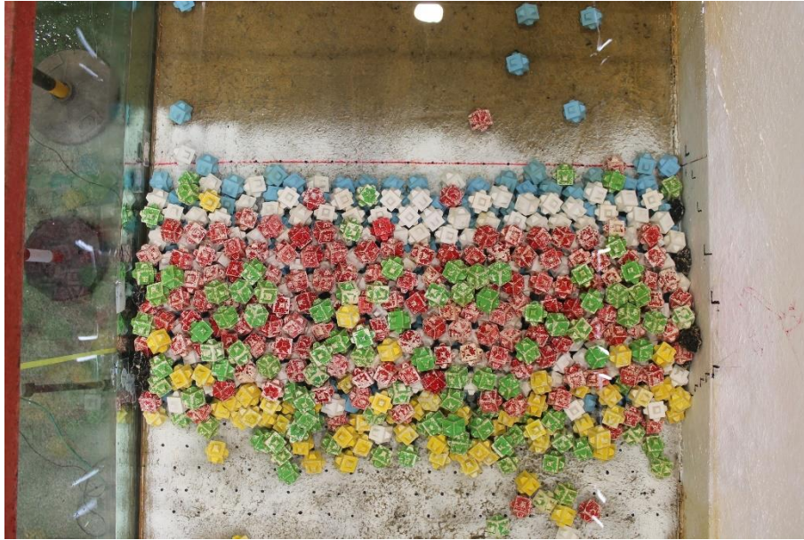
Figura 3.24. Destrucción de la estructura. Fuente: LPC-UPV
