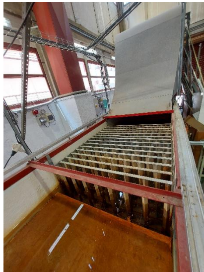
Figura 3.4. Sistema disipador de energía. Fuente: Elaboración propia.
