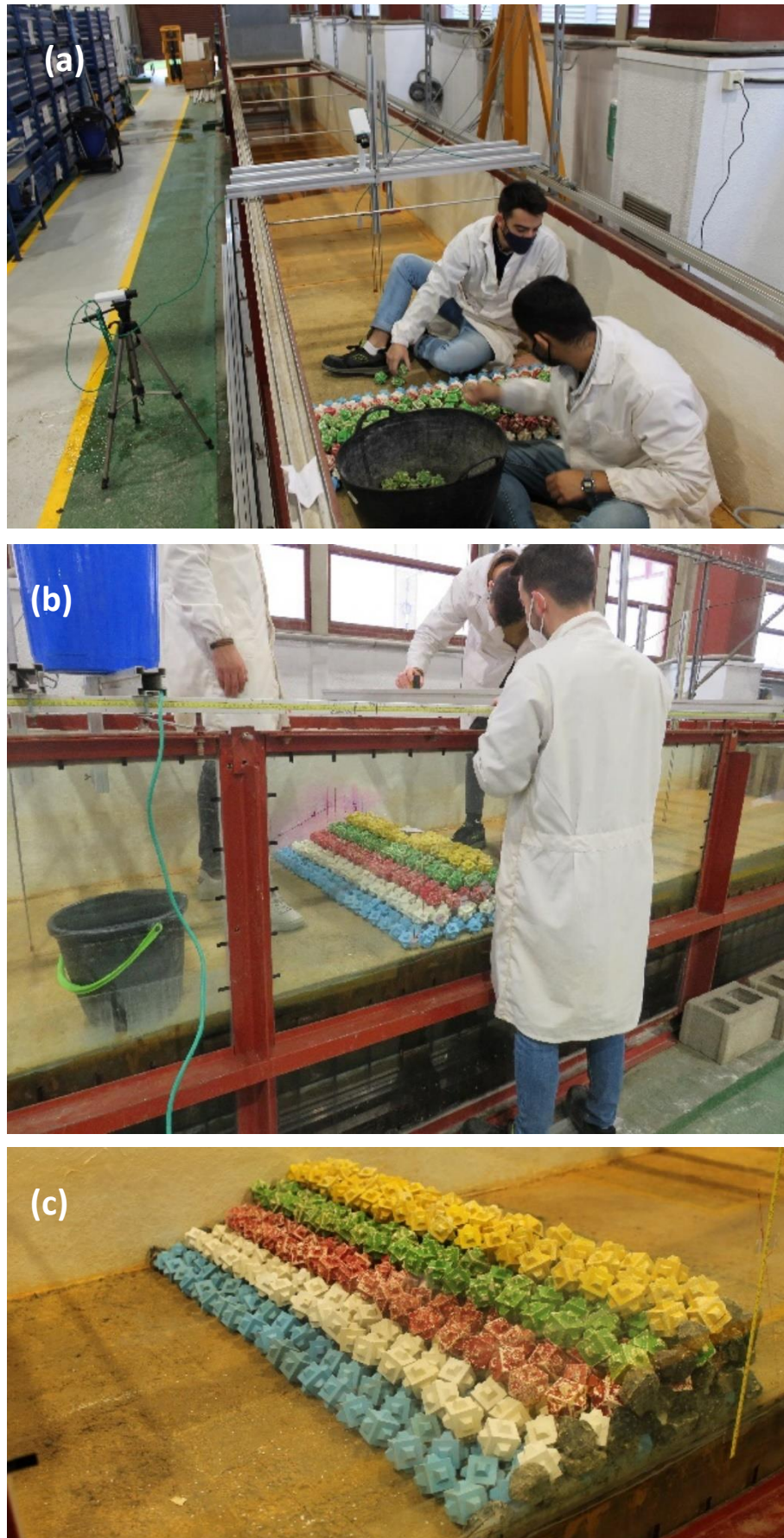
Figura 3.15. Proceso constructivo: (a) Construcción de la 3ª capa (b) Medición de altura de capa (c) Modelo construido. Fuente: Elaboración propia.
