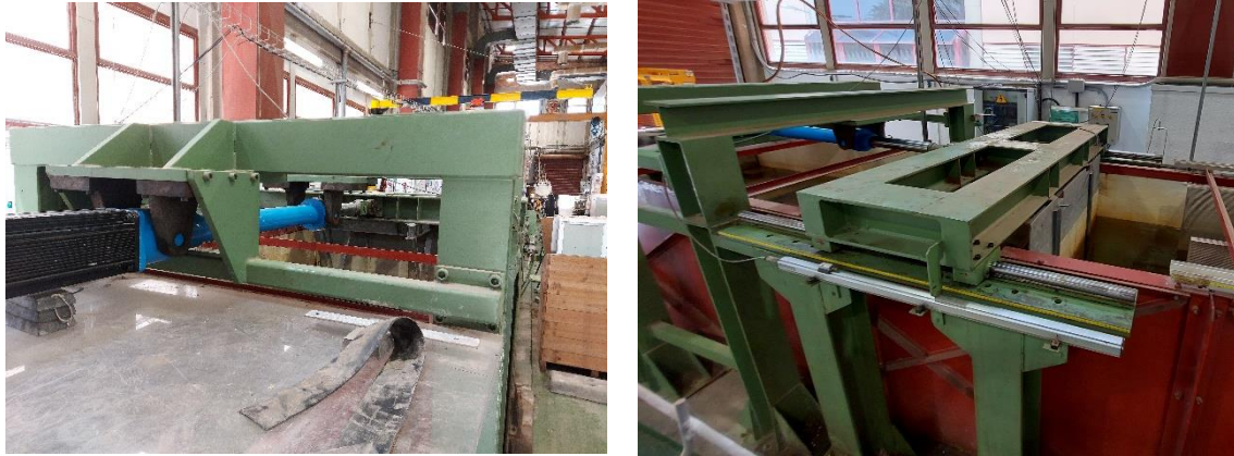
Figura 3.3. Pala generadora de oleaje del LPC-UPV. Fuente: Elaboración propia
