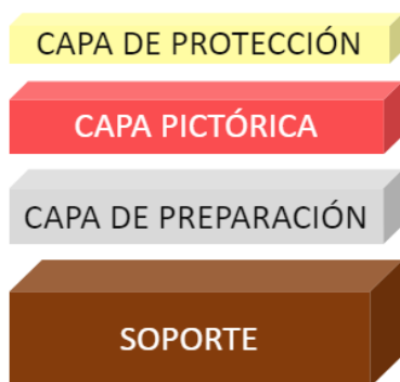
Figura 18. Esquema estructural estratigráfico de una escultura policromada sobre soporte leñoso.
