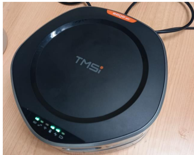
Ilustración 6. Amplificador empleado para el registro de señales modelo TMSi SAGA 32.
