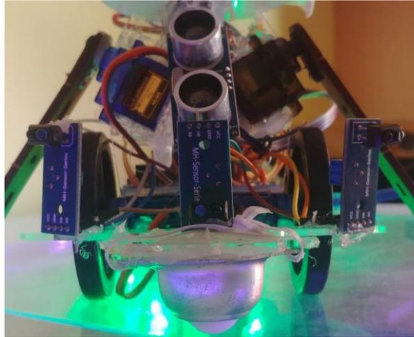
*Ilustración 14: Sensorización final para modo autónomo.*
