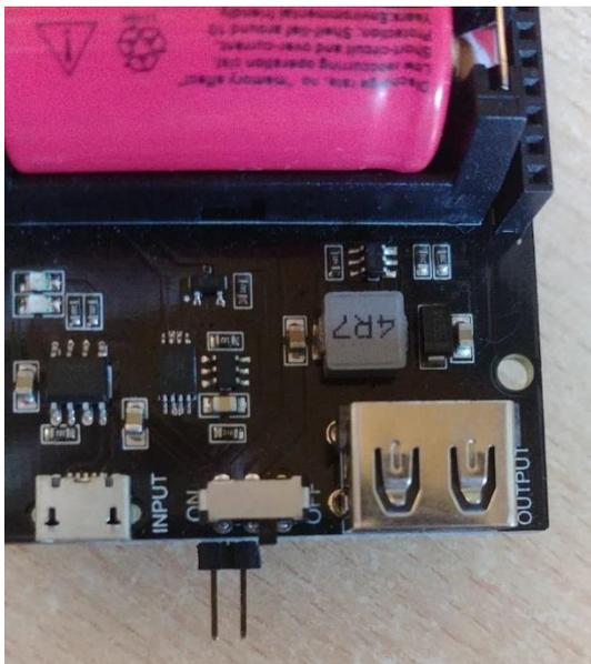
*Ilustración 23: Soldadura de pines machos en switch del módulo 16340.*
