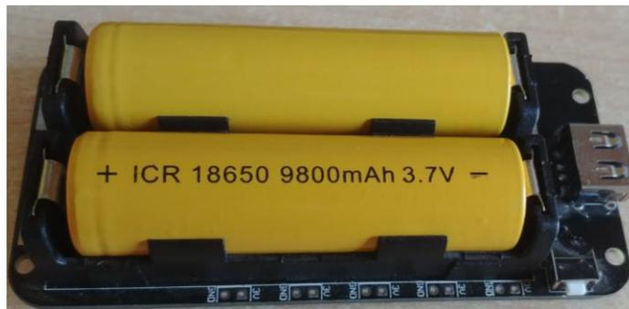
*Ilustración 2: Módulo 18650 de baterías.*
