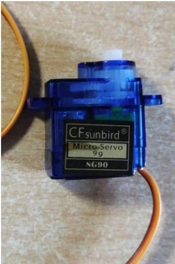
Ilustración 11: Servomotor “SG90”
