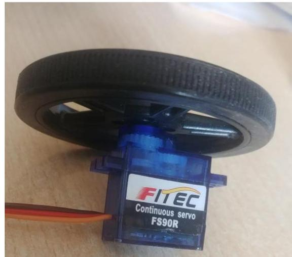
Ilustración 10: Servomotor "FS90R"
