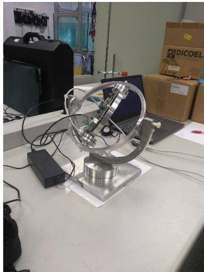
*Fig. 16 CLB en el espacio donde se han realizado todas las calibraciones, libre en mayor medida de elementos magnéticos o ferrosos*
