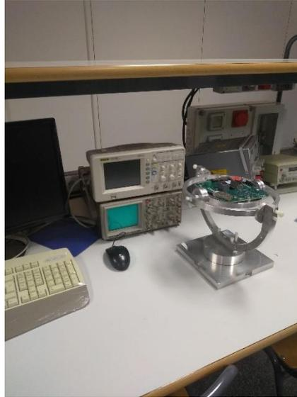
*Fig. 19 CLB expuesta a posibles campos magnéticos inducidos por diferentes aparatos presentes en un laboratorio de electrónica( ordenador, osciloscopio, generadores de señal, ...).*
