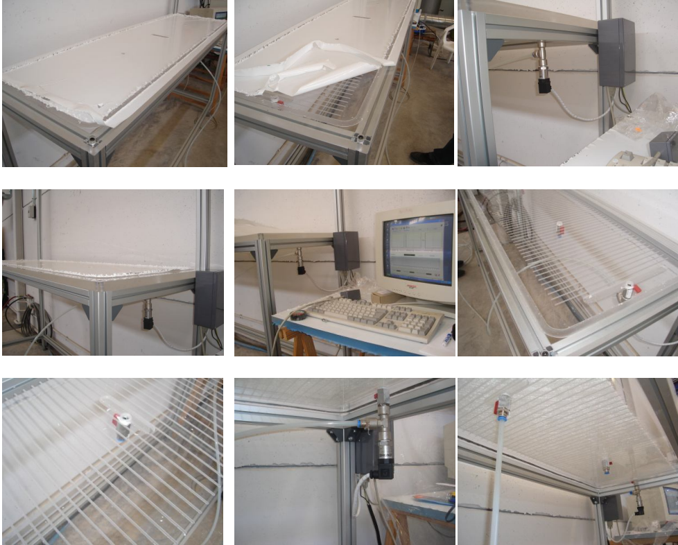
Figura 37.- Ensamblado del banco de permeabilidad
