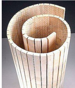
Figura 38.- Cortes longitudinales para el conformado del núcleo
