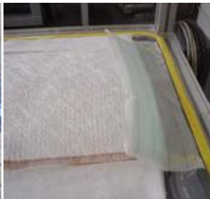
Figura 42.- Preforma colocada sobre el núcleo. Los canales del núcleo distorsionarán el flujo
