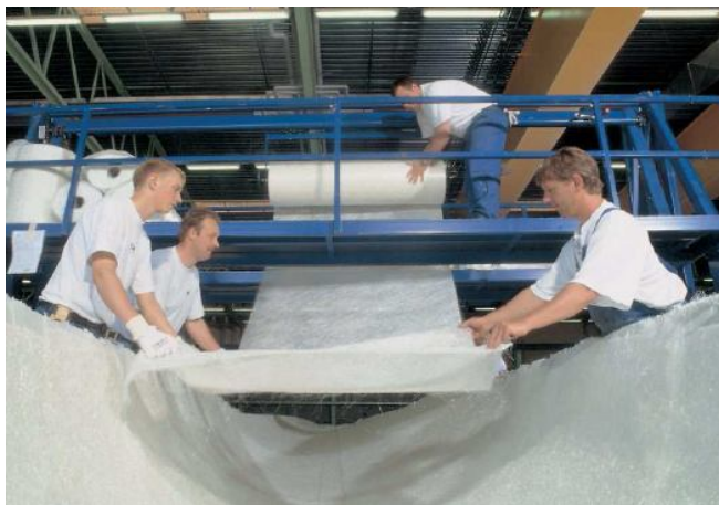
Figura 17.- Conformado del refuerzo sobre el molde
