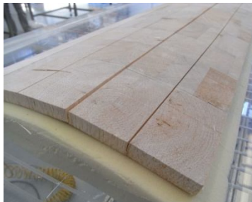
Figura 41.- Canales abiertos en el núcleo por el efecto del radio de curvatura del molde
