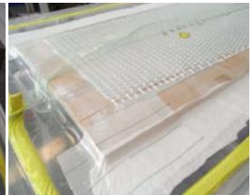
Figura 43.- Dispositivo experimental para el cálculo de la permeabilidad flexible con núcleo
