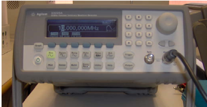
Fig. 4.20. Function generator Agilent 33220A.
