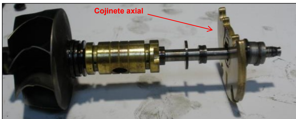
Imagen 2.13 Posición del cojinete en el eje del turbo
