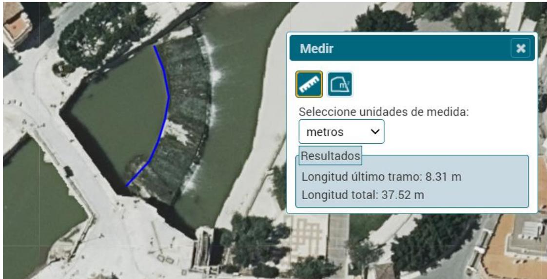
Ilustración 36. Ancho sección crítica azud (Fuente: Visor GVA)
