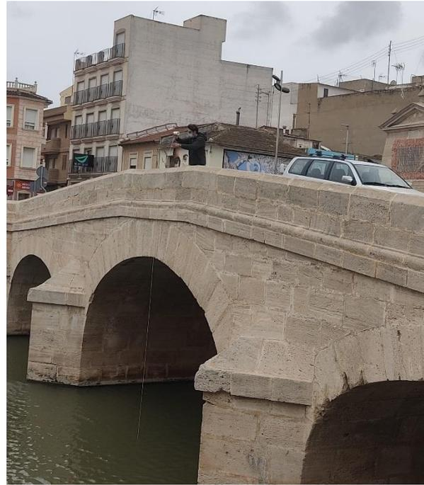
Ilustración 34. Medición de la profundidad in situ.
