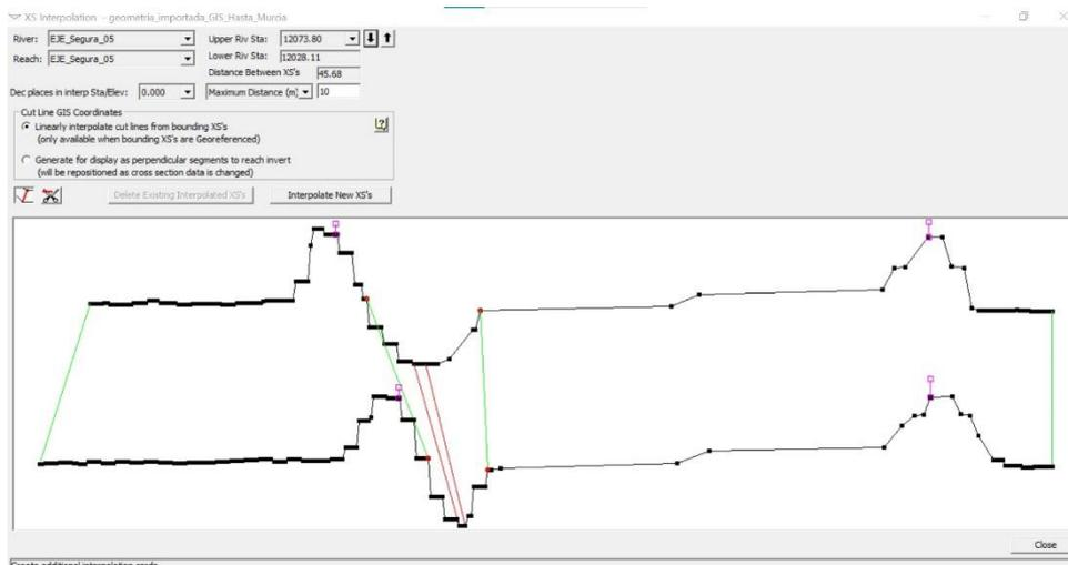
Ilustración 14. Secciones 12028 y 12073 antes de la interpolación. (Fuente: propia)
