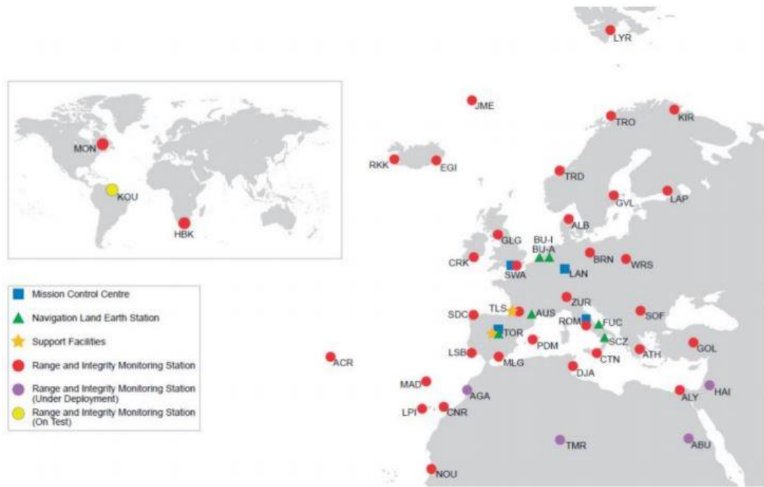
Figura 3.1: Distribución de las instalaciones del Segmento Terrestre de EGNOS [19]
