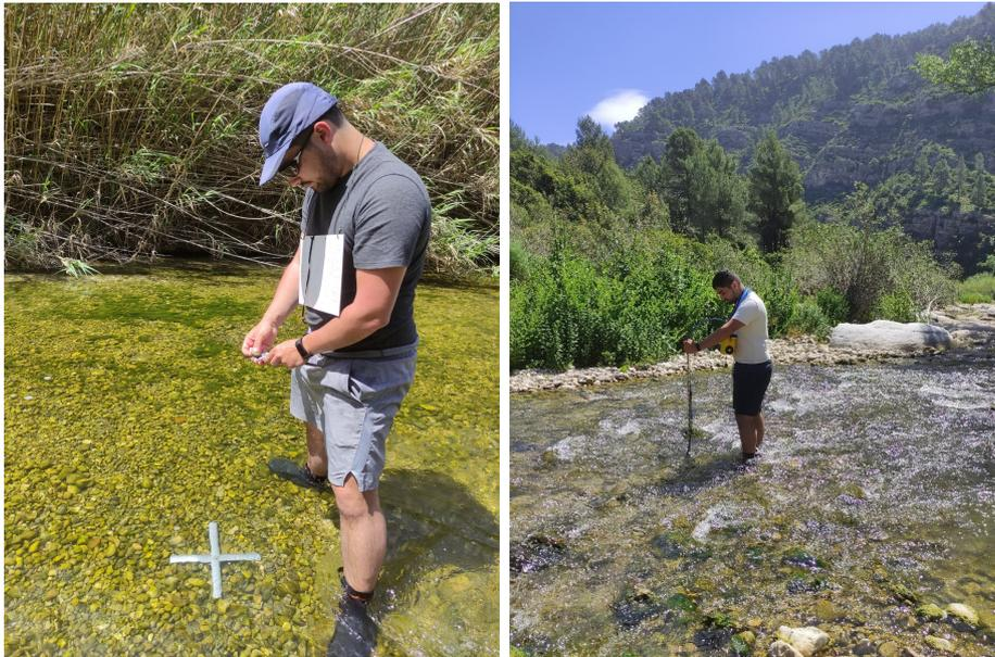
Figura 3.2: A la izquierda: instrumento de fabricación casera para conocer los puntos de muestreo de textura: las marcas de las pulgadas coinciden con las doce mediciones. A la derecha: toma de velocidades en un rápido, río Serpis.
