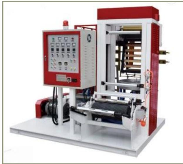
Figura 196.- Máquina Extrusora de películas de Metacrilato (173)
