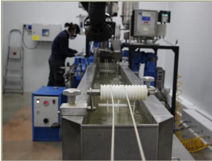
*Figura 145.-Proceso de extrusión de polímeros (137)*
