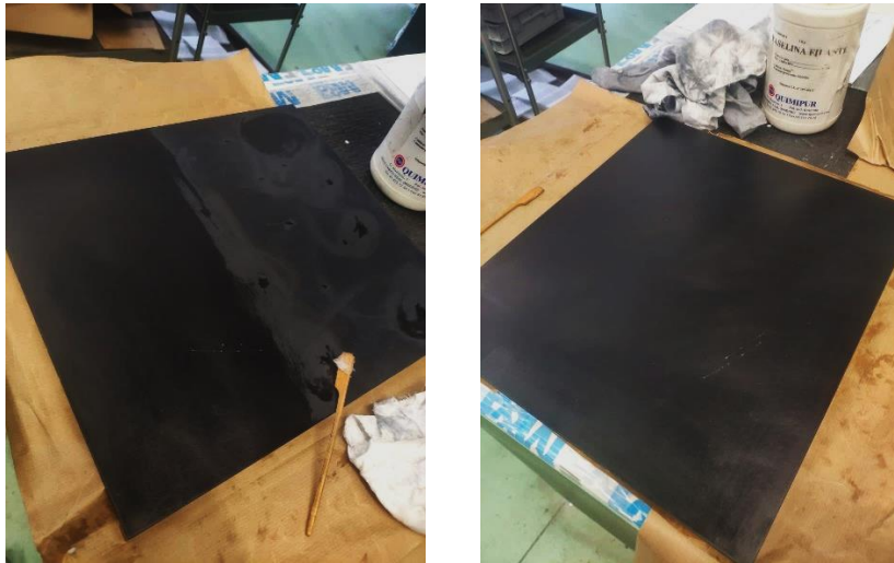
Fig 119. Pedestal tratado para un acabado uniforme.
