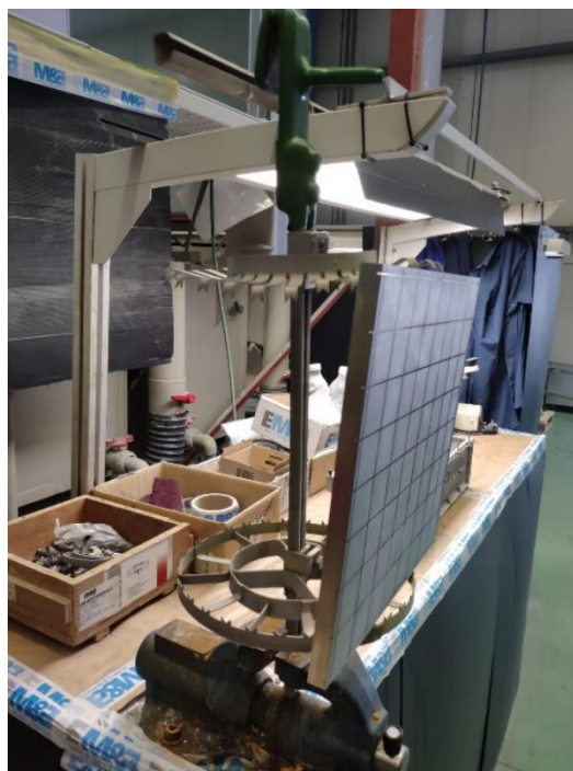
Fig 116. Colocacion del tablero para el anodizado.
