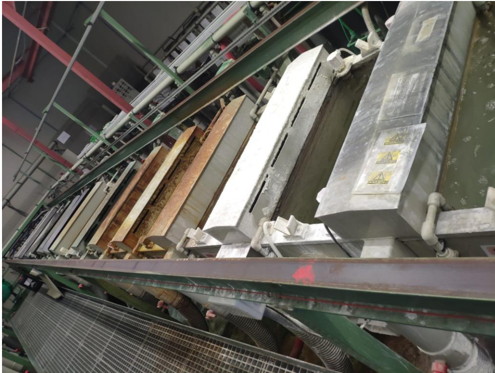
Fig 112. Cubas del proceso de anodizado.
