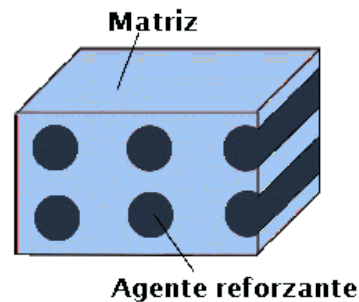
Figura 2.1: Fases de un material compuesto [4]
