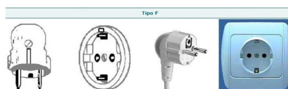
FIGURA4 -Enchufe tipo F
